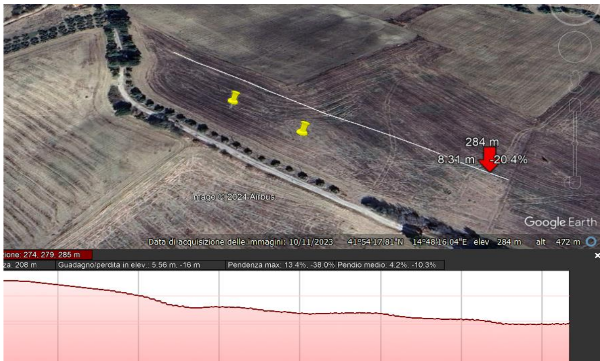
Profilo geomorfologico NW-SE delle aree dei sostegni 167N-1 e 168N-1.
