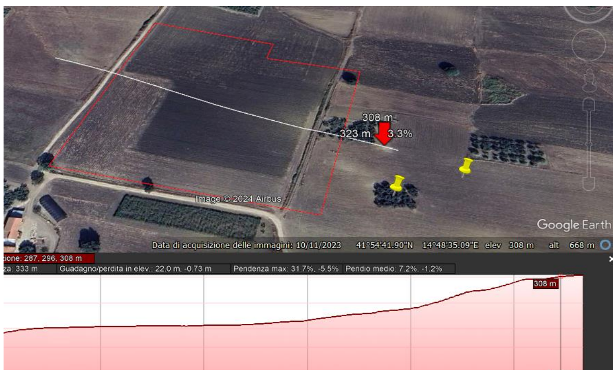
Profilo geomorfologico ESE-WNW dell'area della stazione elettrica.
