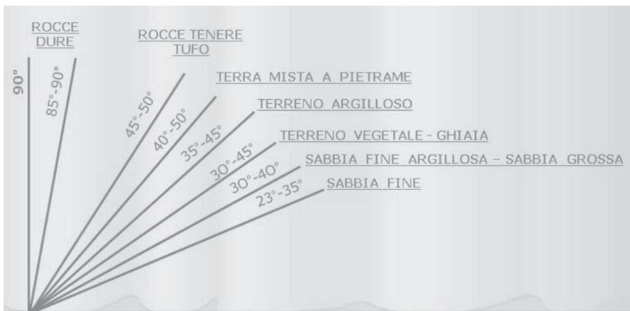
Abaco per la determinazione dell'angolo di natural declivio per varie litologie/terre
