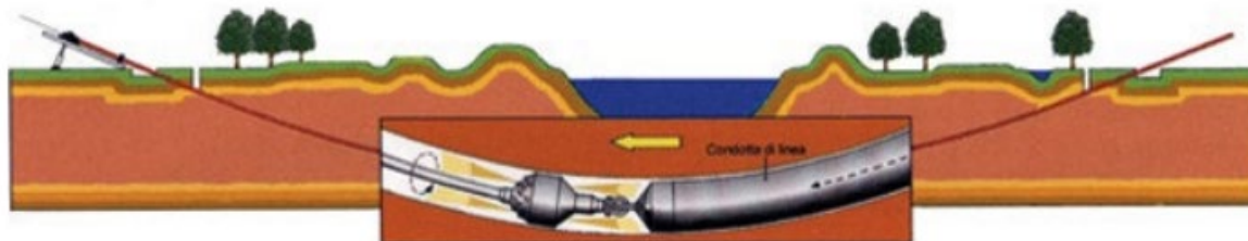
Figura 3. Tecnologia di trivellazione orizzontale controllata (TOC)
