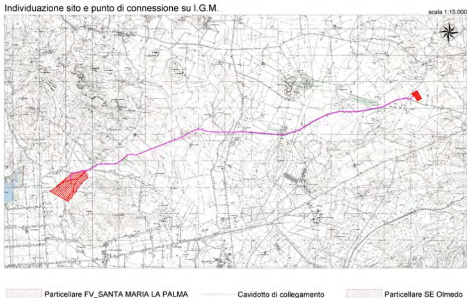
Figura 5 – Percorso del cavidotto di connessione su I.G.M.
