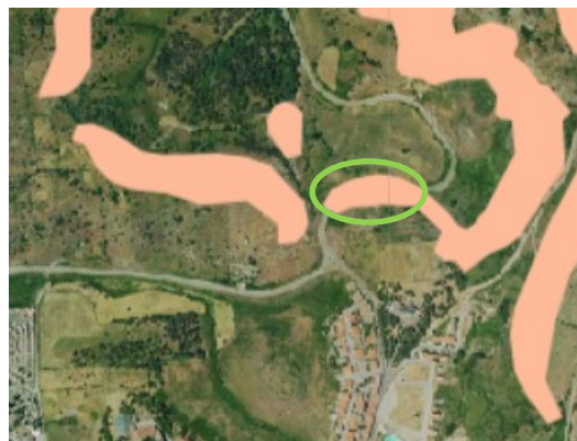
○ Tratto del cavidotto lungo la SP 43 ricadente in Area Hg3 per frana
