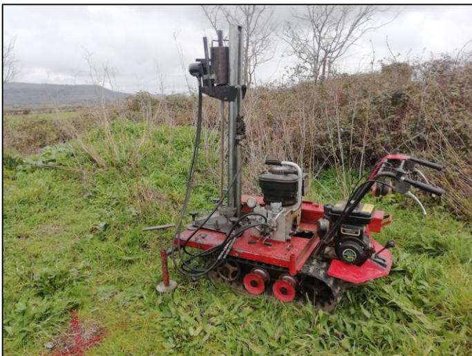
Figura 11.2 – esecuzione prova DIN 1
