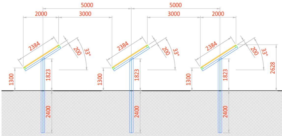
Figura 4.2 - Particolare costruttivo struttura fissa
