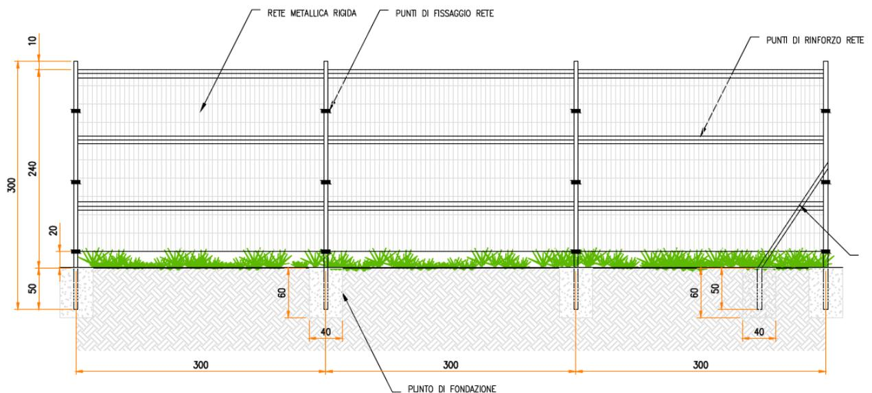
Figura 5.1 - Particolare costruttivo recinzione
