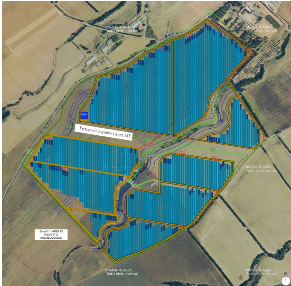
Planimetria di progetto su ortofoto con evidenza del rispetto dell'area archeologica individuata.
