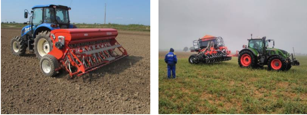
Figura 30: esempio di trattore agricola a lavoro rispettivamente con seminatrice adatta a terreno lavorato e seminatrice su sodo.
