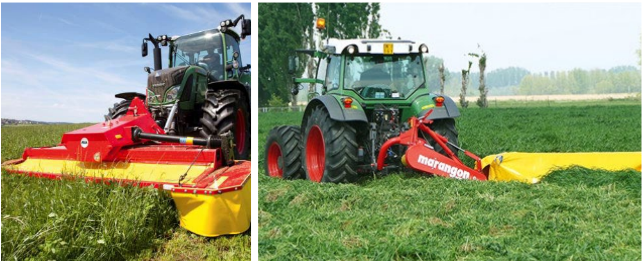
Figura 31: esempio di trattore agricola a lavoro rispettivamente con falciacondizionatrice frontale e posteriore.
