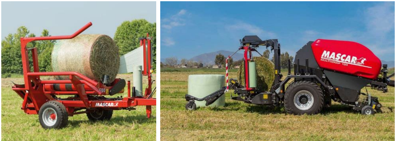
Figura 33: esempio di fasciatore trainato ed abbinato in serie alla rotopressa.
