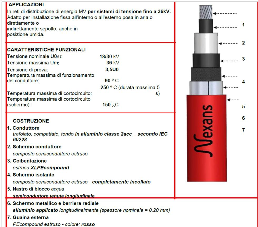
Caratteristiche e parti costituenti il cavo ARE4H5E 18/30kV
