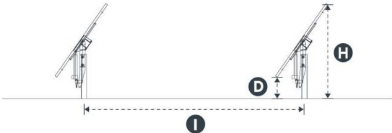
Figura 2 - Sezione trackers e moduli in progetto (D = 1,30 m, H = 5,20 m, I = 8,00 m)..
