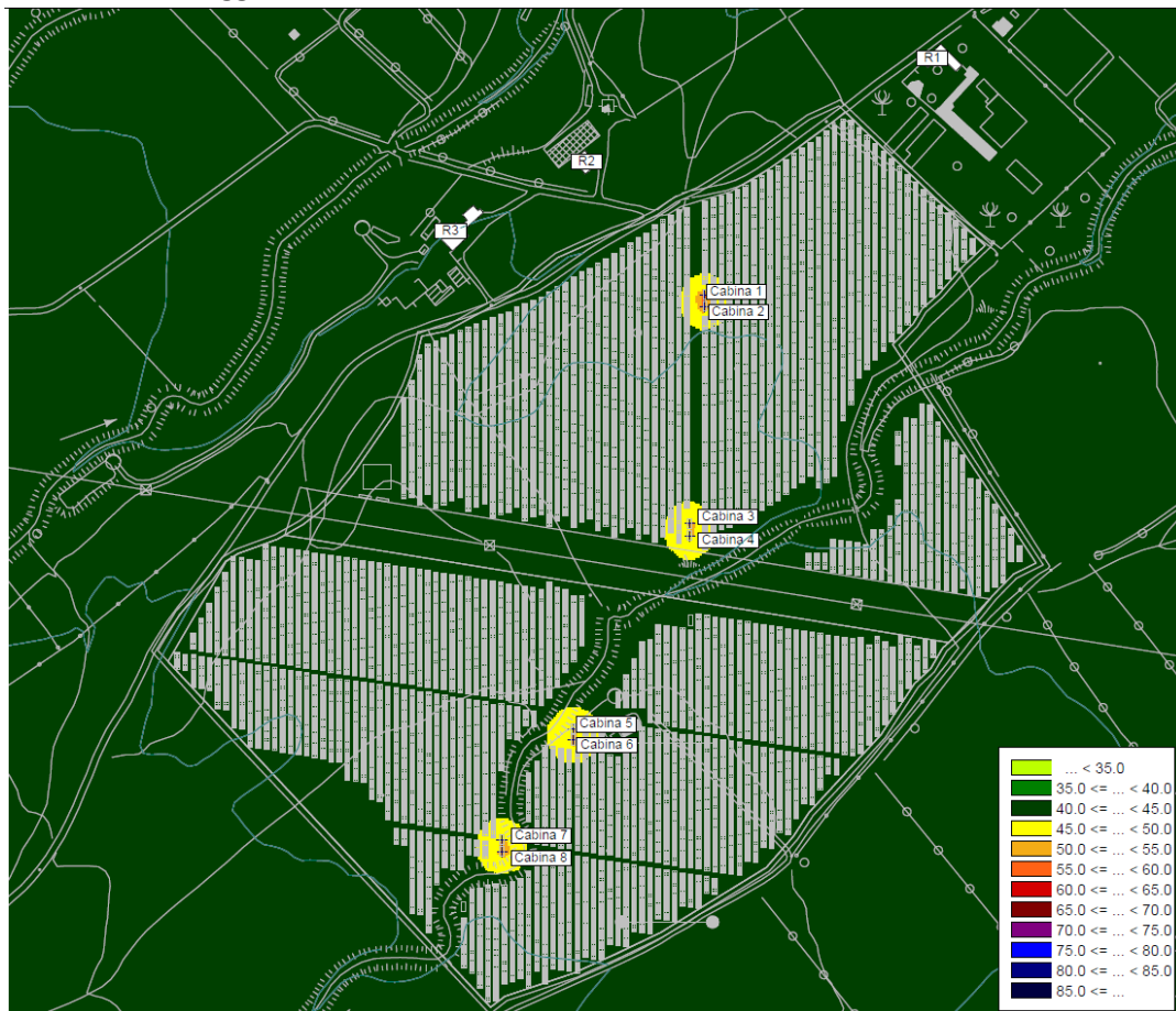
Figura 9 – rappresentazione grafica immissione diurna globale impianto, con identificazione delle sorgenti.
