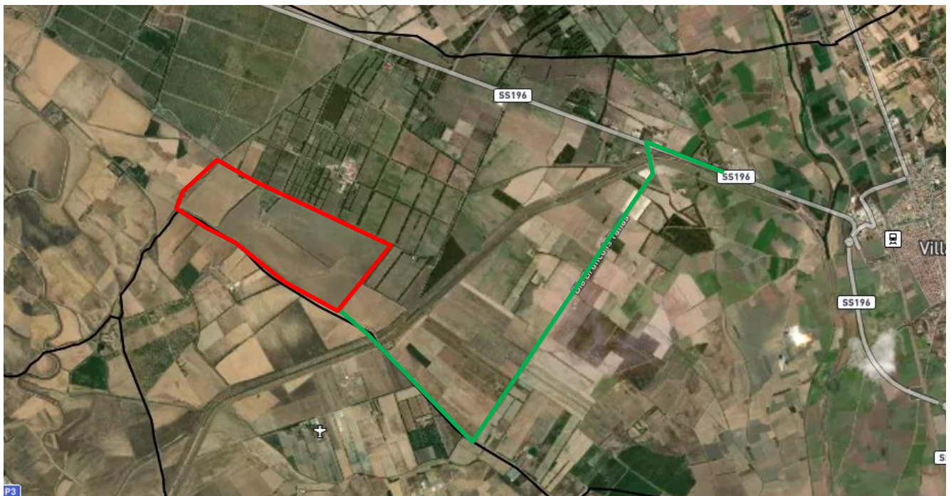
Fig. 7.1.1/A: perimetrazione aree a pericolosità idraulica
