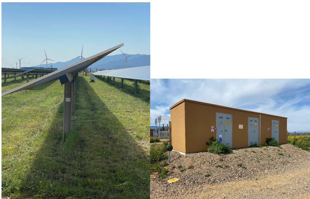
Figura 5 - tipologia tracker e tipologia cabina inverter
