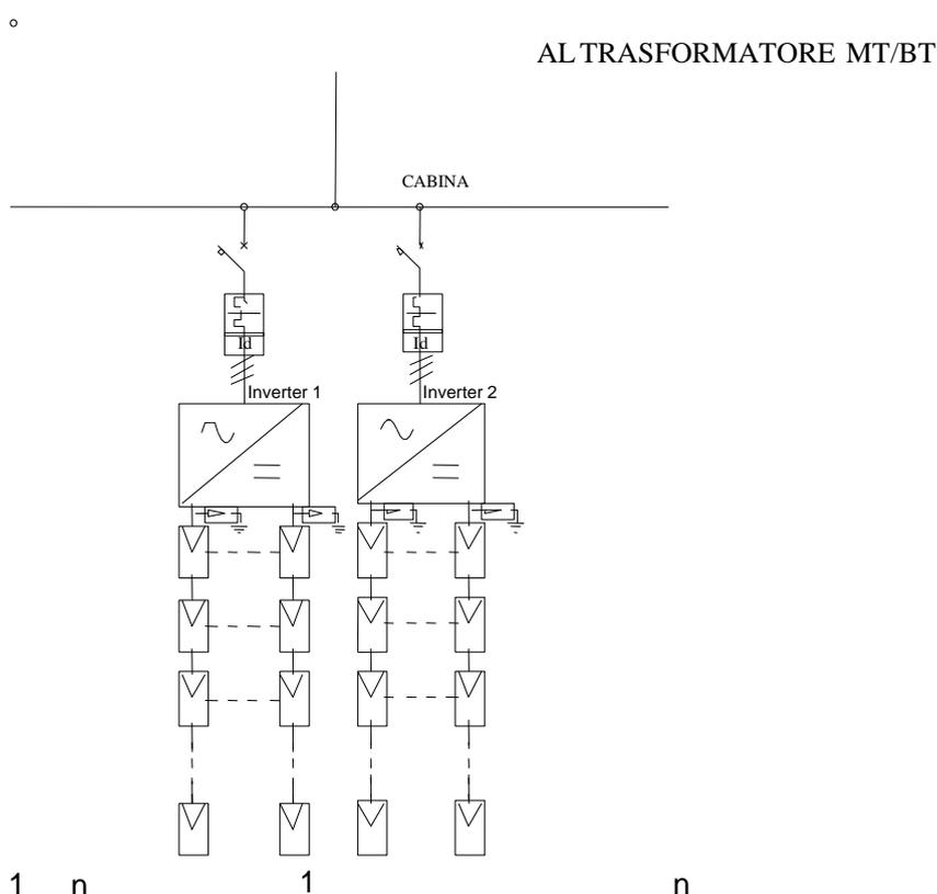
**Figura 10:** schema unifilare di principio dell'impianto fotovoltaico
