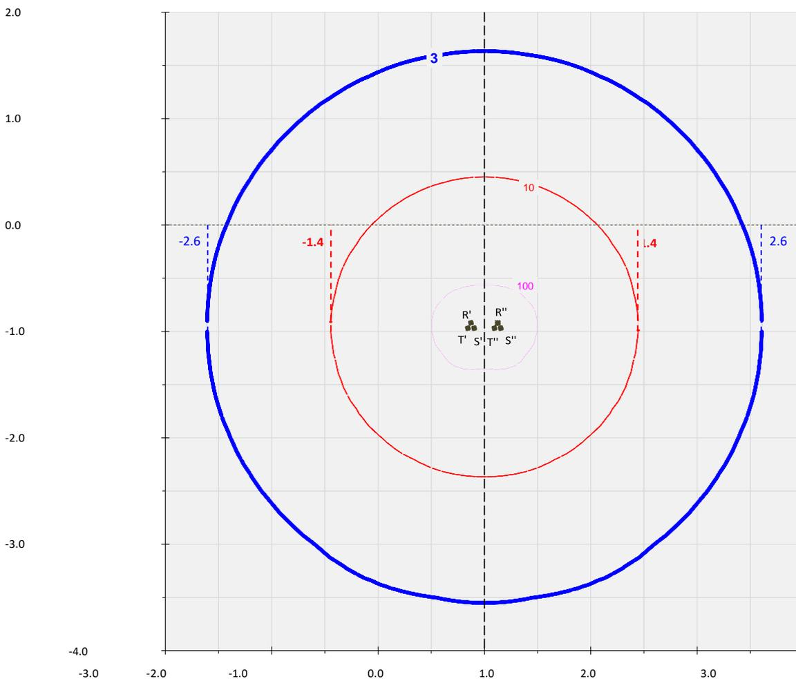
Figura 5: Curve di equivello per il campo di induzione magnetica generato da una linea MT posata a trifoglio ( $I_{max}=710^A$ ; formazione (3x1x630))
