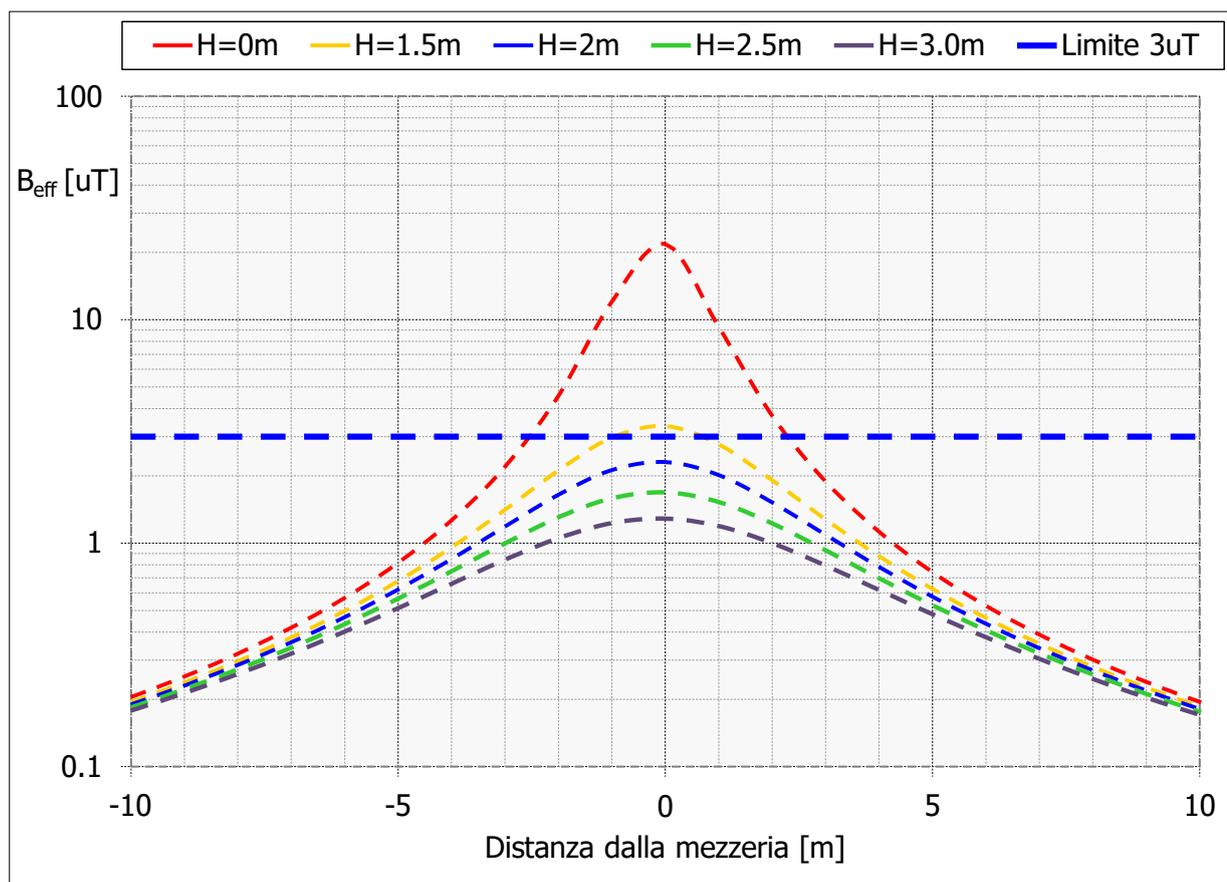
Figura 3: Andamento dell'induzione magnetica prodotta dalla linea in cavo per la massima corrente del cavo
