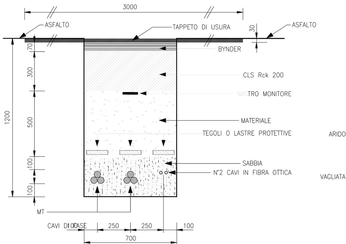
Figura 2: Sezione tipica di posa della linea in cavo su sedestrada
