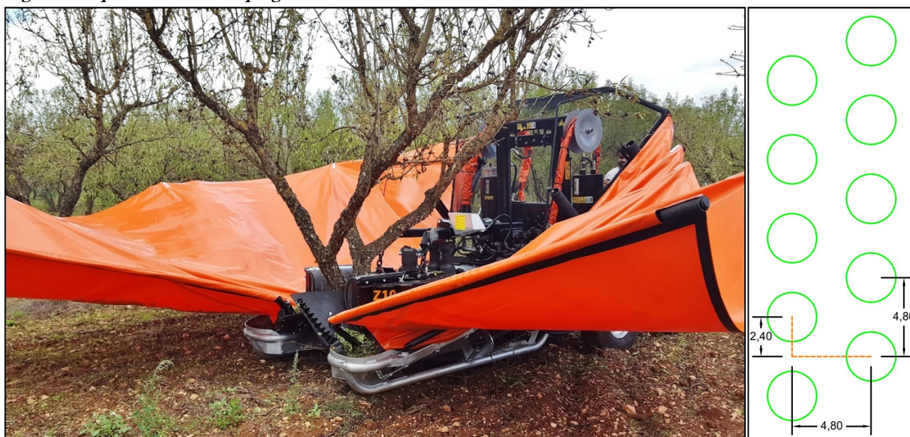
Figura 1.1. Macchina frontale per la raccolta delle mandorle/olive su impianto intensivo e disposizione ideale degli alberi per il corretto impiego della stessa
