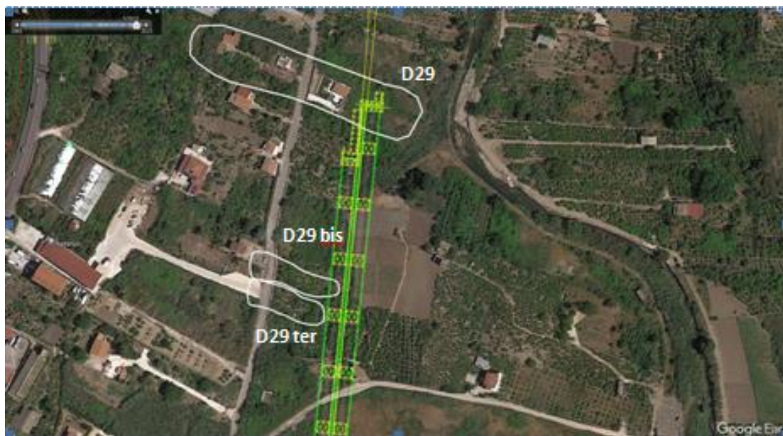
Figura 8-50: Stralcio di foto aerea da Google Earth con ubicazione dei dissesti e del tracciato.
