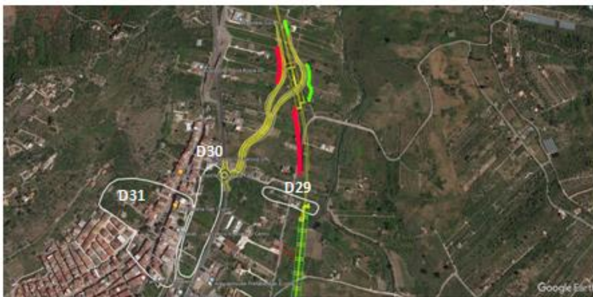
Figura 8-52: Stralcio di foto aerea da Google Earth con ubicazione dei dissesti e del tracciato dello svincolo
