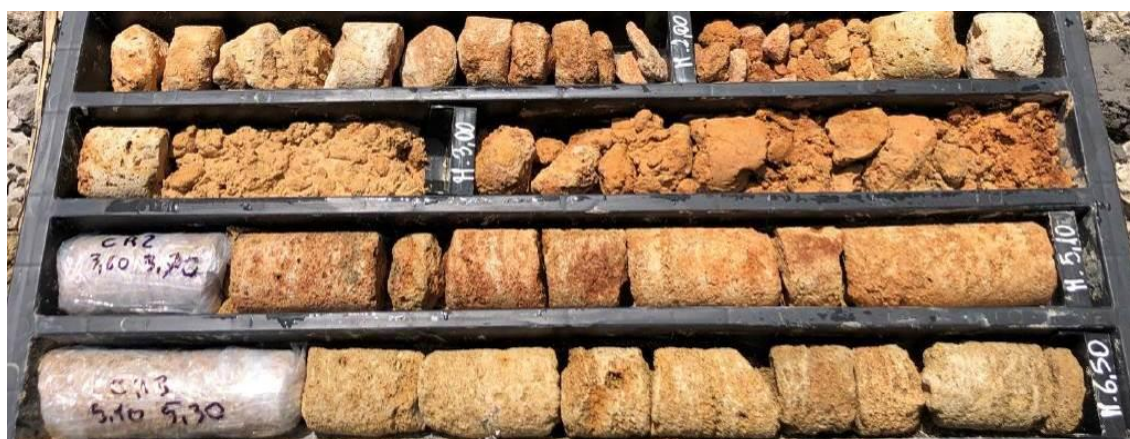
Fig. 8-1 Sondaggio S01_PZ. calcarenite CL
