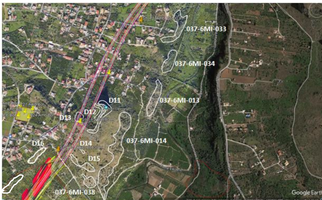
Figura 4-18: Stralcio di foto aerea da Google Earth con ubicazione dei dissesti e del tracciato.
