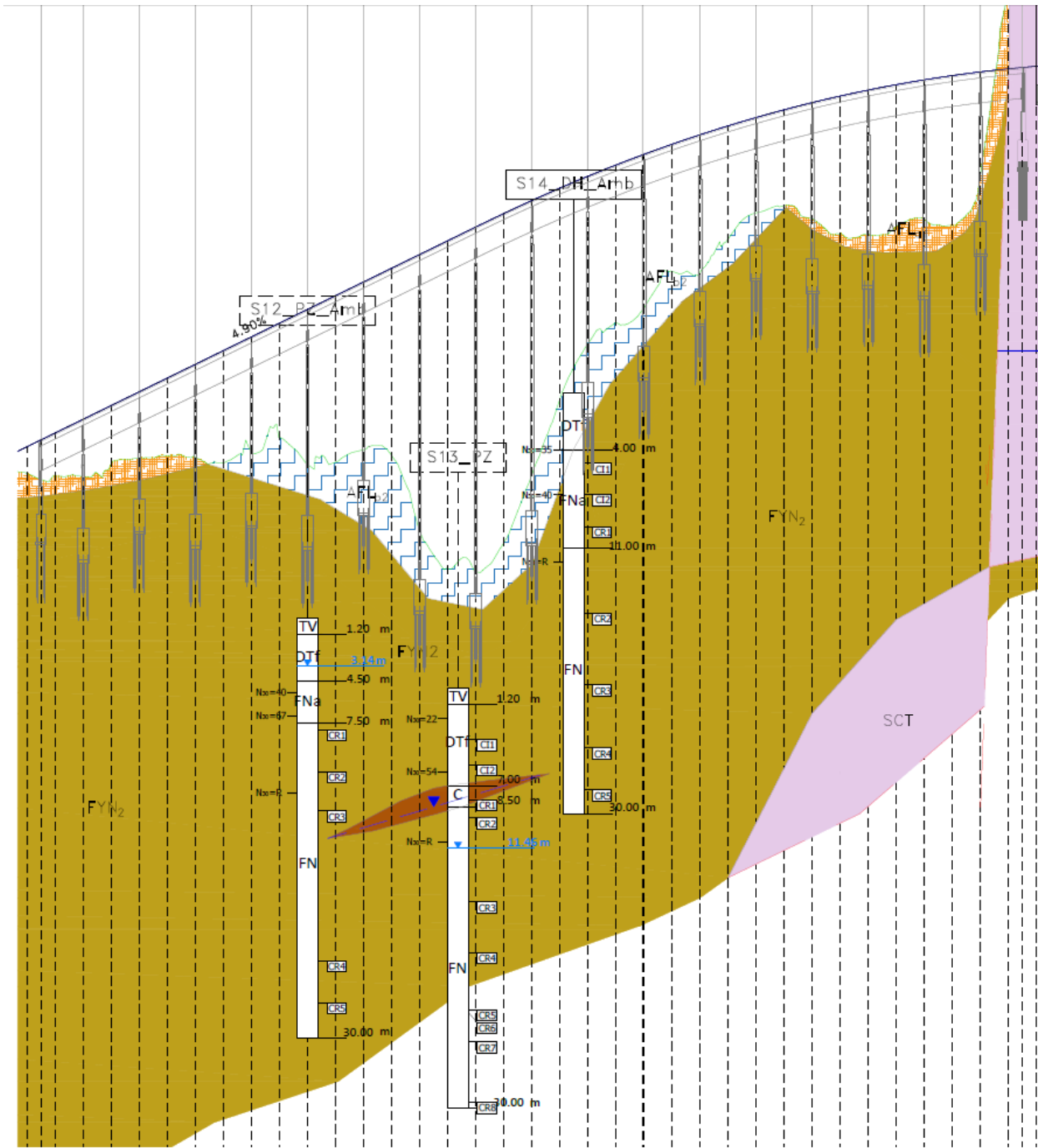
Figure 8-33 :Profilo geologico del tracciato, tratto compreso tra la progressiva 3+690.00 e la progressiva 4+390.00
