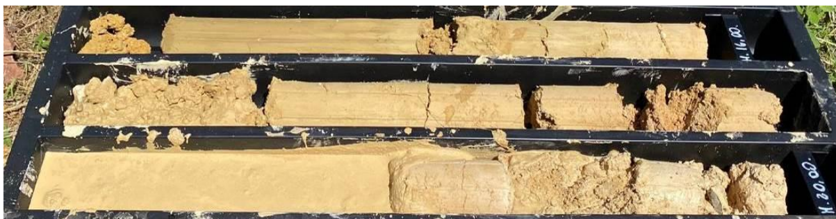
Fig. 8-2 Sondaggio S01_PZ da 15 m a 20 m. Alternanza di sabbia calcarenitica SC e calcarenite CL
