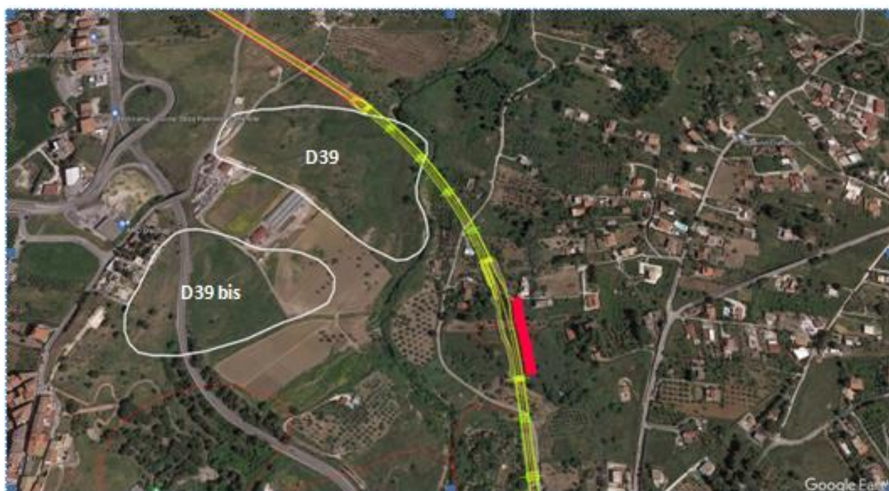
Figura 4-47: Stralcio di foto aerea da Google Earth con ubicazione dei dissesti e del tracciato.
