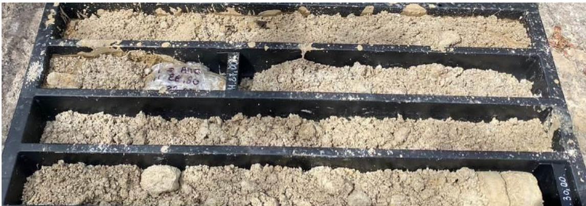
Figura 6-46: Calcari Cf lungo il sondaggio S11\_PZ\_ Amb tra 25,50 m e 30,00 m.
