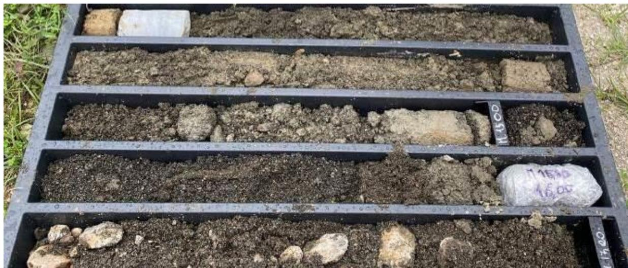
Figura 6-54: Radiolariti R lungo il sondaggio S9\_PZ tra 12,00 m e 17,00 m.
