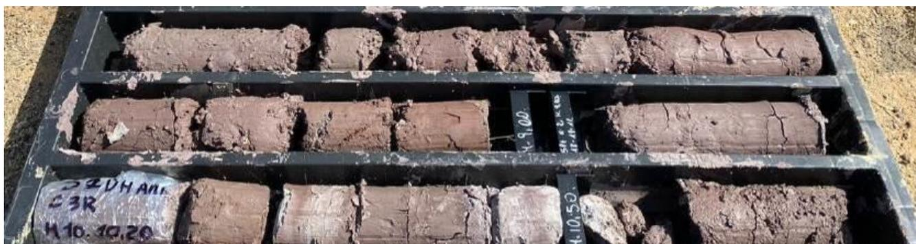
Figura 6-40: Marna argillosa CM lungo il sondaggio S7\_DH\_Amb tra 7,50 m e 10,50 m.
