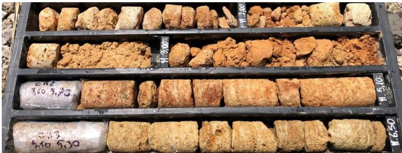
Figura 6-45: Calcarenite CFC lungo il sondaggio S5\_PZ\_ Amb tra 1,00 m e 6,50 m.
