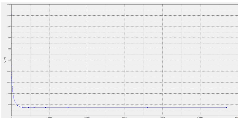
Figura 12-35: V Schema.  $H_{calcolo} = 8\text{ m}$  – Andamento dei cedimenti nel tempo in presenza di bonifica
