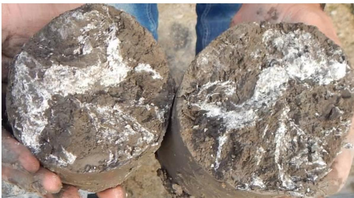
*Figura 6-27: Argilla scagliettata FN con spalmature di dickite (S23\_DN\_ Amb - profondità di 20,5 m).*
