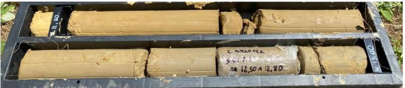
Figura 6-23: Limo argillosa LA lungo il sondaggio S01\_PZ tra 11 m e 13 m.
