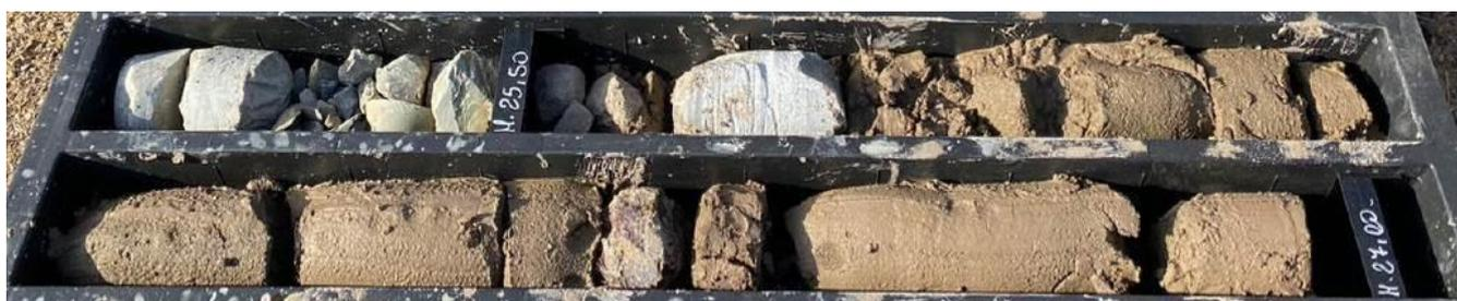
Figura 6-51: Calcare C lungo il sondaggio S7\_DH\_ Amb tra 22,50 m e 27,00 m.
