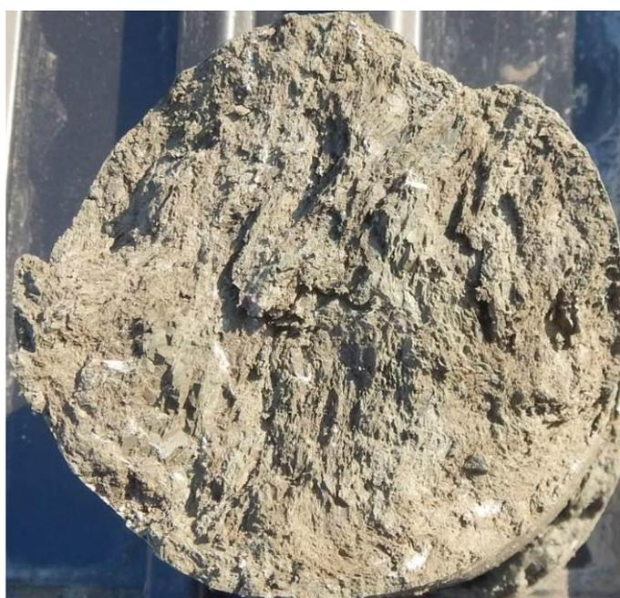
Figura 6-25 Argilla scagliettata FN prelevata lungo il sondaggi S35\_PZ\_Amb alla profondità di 15 m.
