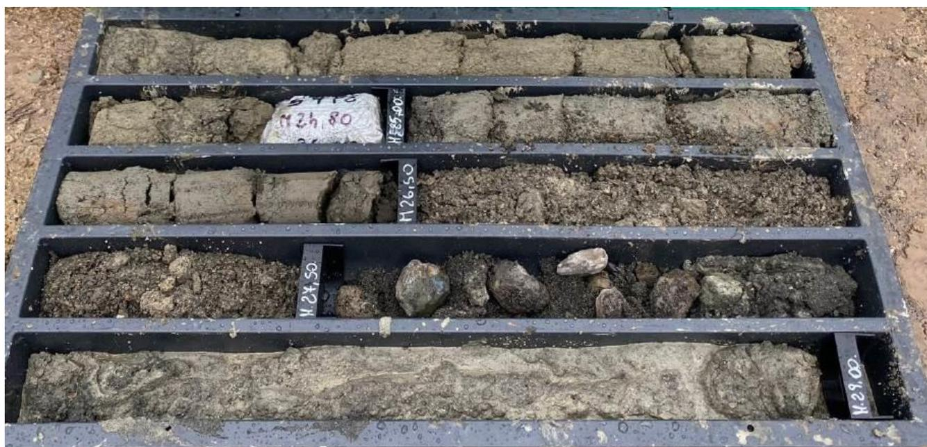
Figura 6-55: Radiolariti R lungo il sondaggio S9\_PZ tra 22,70 m e 29,00 m.
