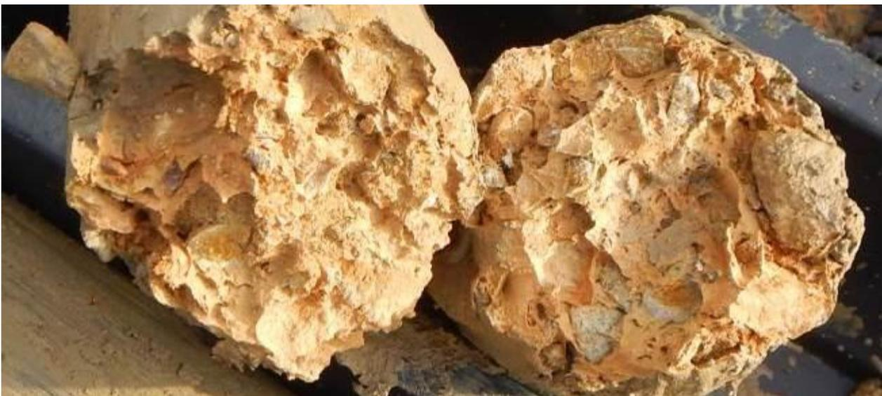
Figura 6-5: Detrito a grana fina DTF lungo il sondaggio S07\_DH\_Amb a 7,00 m.
