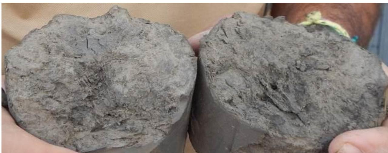
Figura 6-24 Argilla scagliettata FN prelevata lungo i sondaggi S23\_DH\_Amb alla profondità di 8.5 m.
