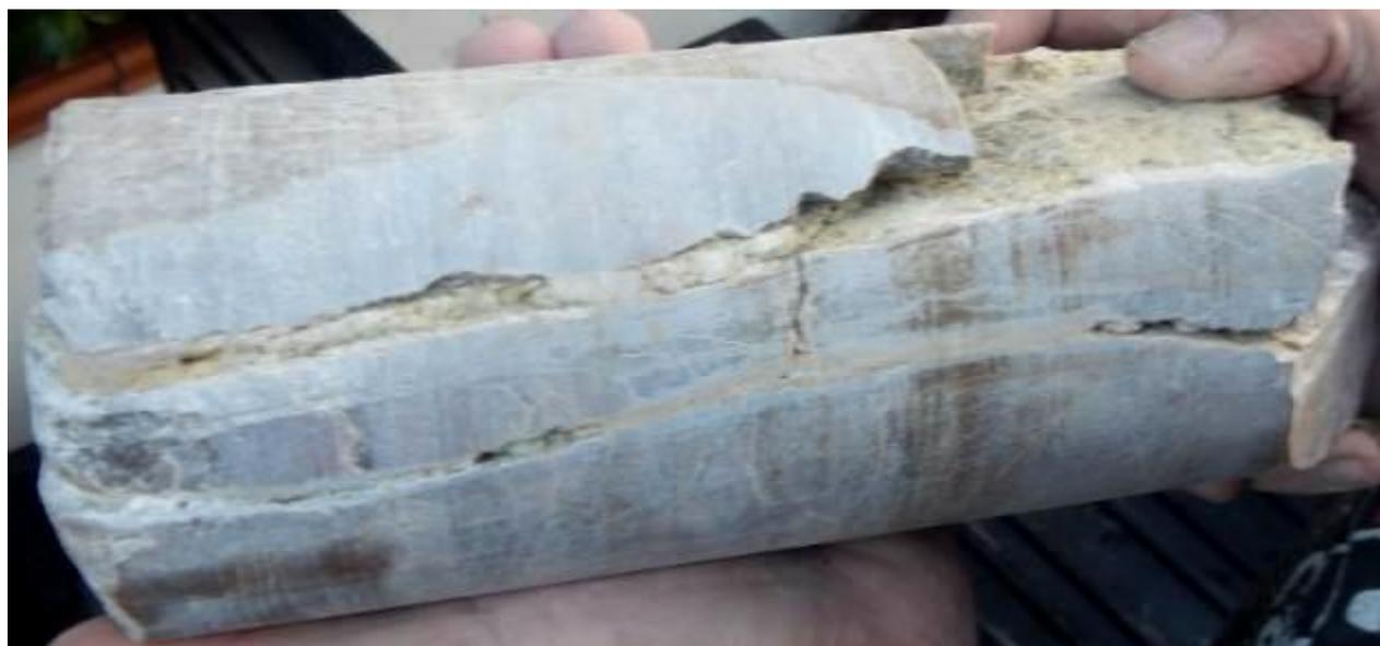
*Figura 6-48: Calcarea C lungo il sondaggio S8\_PZ\_Amb a 12,80 m. Discontinuità riempite da materiali di varia natura*
