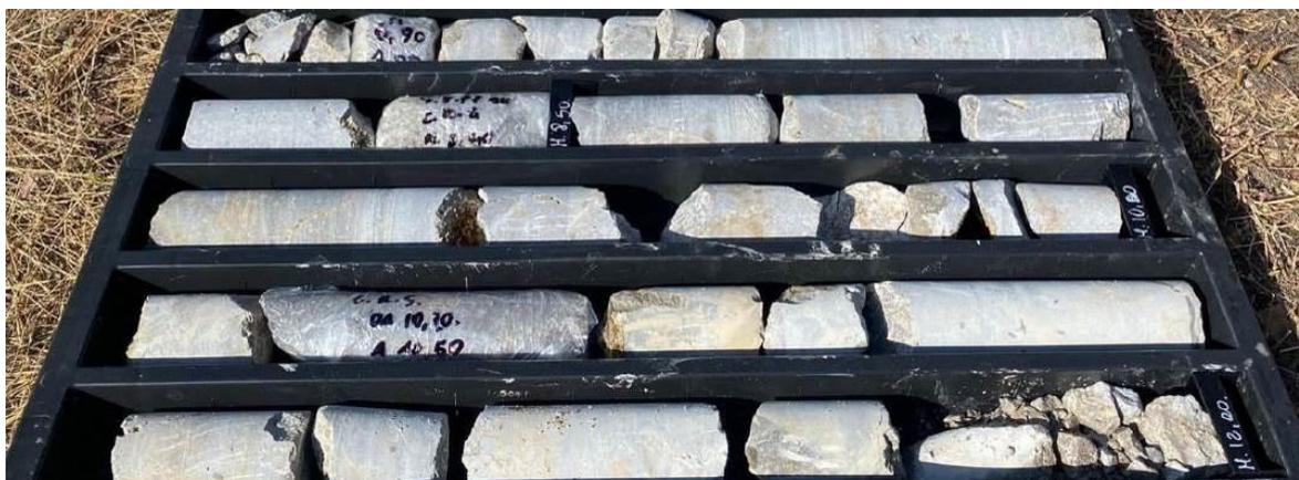
Figura 6-47: Calcare C lungo il sondaggio S8\_PZ\_Amb tra 6,70 m e 12,00 m.
