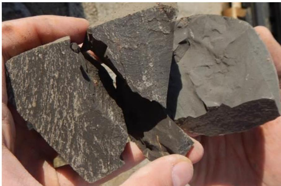
*Figura 6-26 Argilla marnosa FN prelevata lungo il sondaggio S14\_DH\_Amb.*
