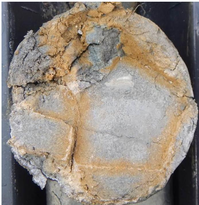
*Figura 6-56: Quarzosiltiti Q lungo il sondaggio S36\_DH\_Amb a 6,3 m.*
