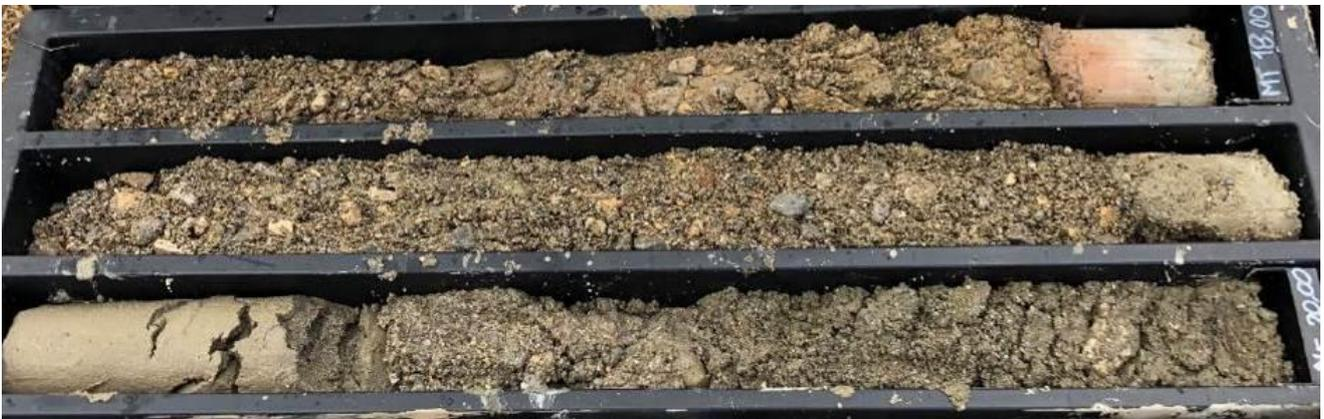
Figura 6-16: Alluvioni a grana grossa ALG lungo il sondaggio S06\_PZ tra 17 m e 20 m.
