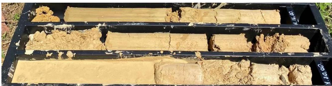
Figura 6-18: Sondaggio S01\_PZ da 15 m a 20 m. Alternanza di sabbia calcarenitica SC e calcarenite CL
