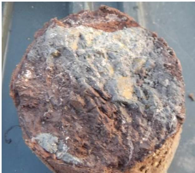
Figura 6-41: Sondaggio S7\_DH\_ Amb. Profondità a 9 m – Marna argillosa CM con tessitura scagliosa.
