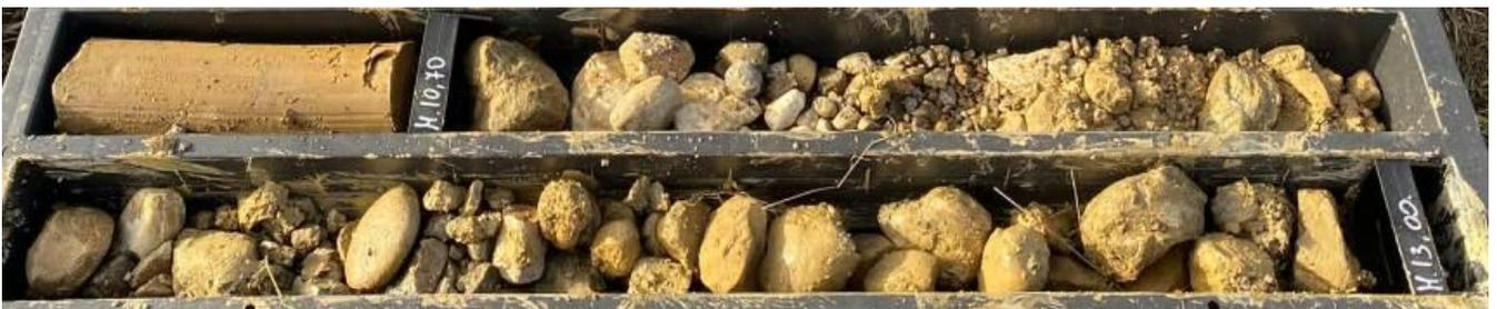
Figura 6-17: Alluvioni a grana grossa ALG lungo il sondaggio S45\_PZ\_Amb tra 10,7 m e 13,0 m.
