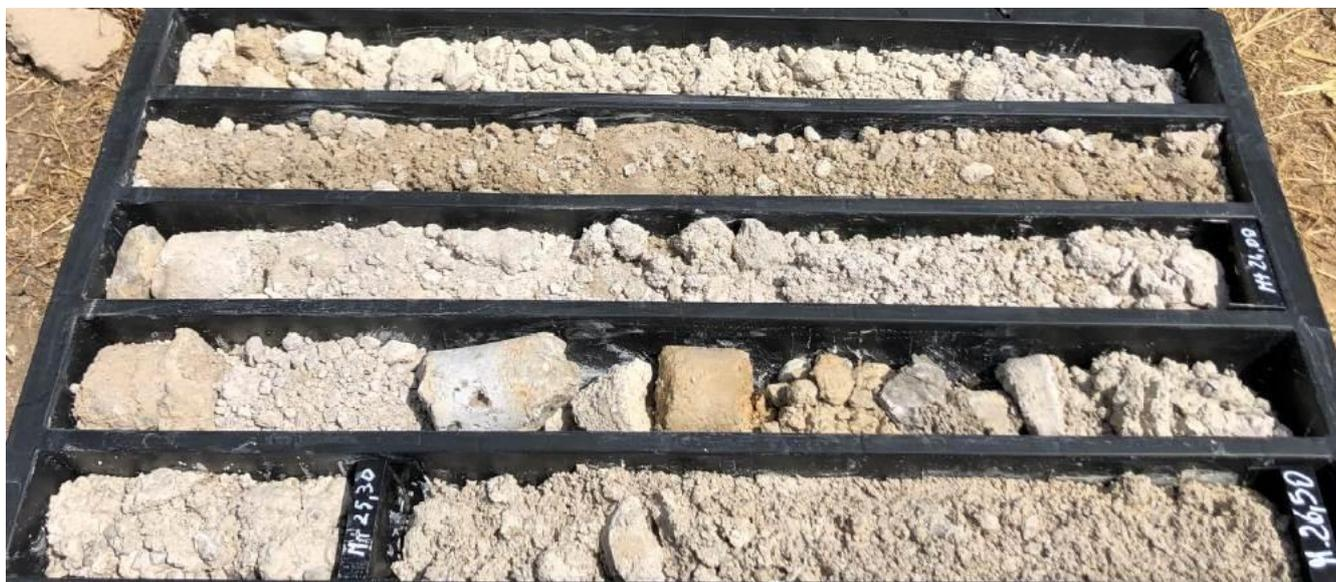
Figura 6-50: Breccia calcarea C lungo il sondaggio S3\_PZ tra 21,0 m e 26,5 m.
