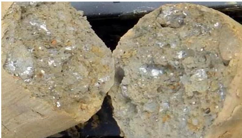
Figura 6-6: Detrito a grana fina DTF lungo il sondaggio S32\_DH\_Amb a 9,00 m.
