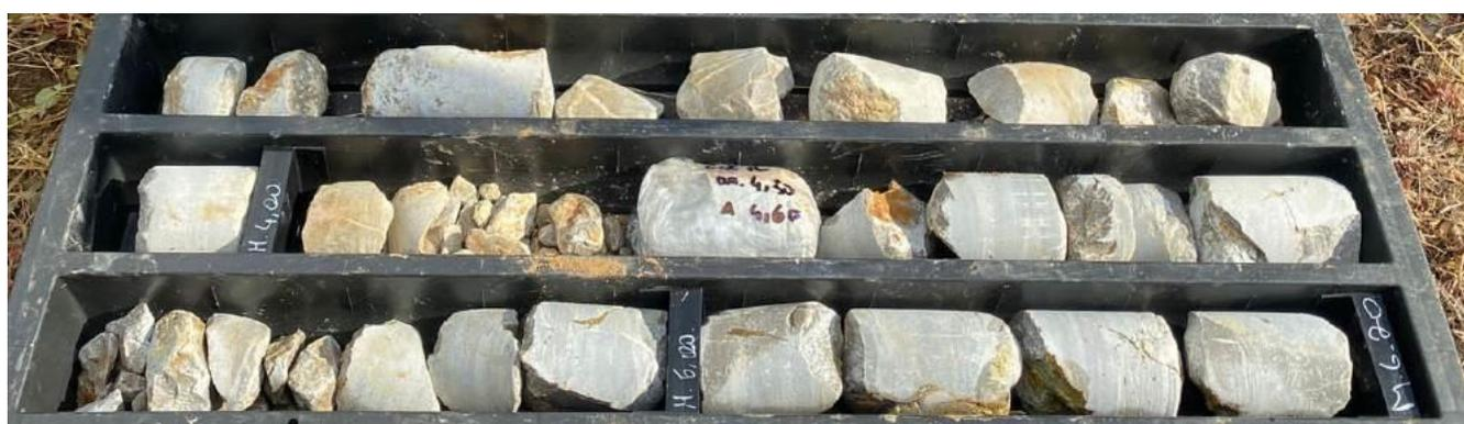
*Figura 6-49: Calcarea C lungo il sondaggio S8\_PZ\_Amb tra 2,50 m e 6,00 m.*
