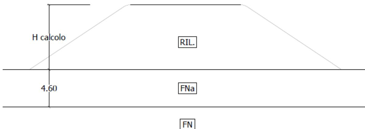
Figura 12-4: IV Schema. Rilevato tra pk 12+923 e pk 13+446 – Schema fisico di riferimento per il calcolo dei cedimenti.
