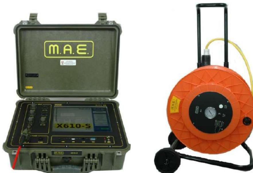
**Figura 2.** Sismografo digitale X610-S (a sinistra) e geofono triassiale da foro S3 (a destra) della M.A.E..
