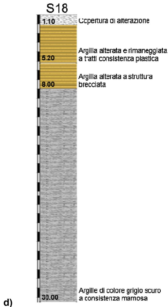
**DH\_S18.** a) tempi corretti delle onde P (in rosso) ed S (in blu) in funzione della profondità; b) velocità d'intervallo in funzione della profondità; c) rapporto di Poisson in funzione della profondità; d) colonna stratigrafica.
