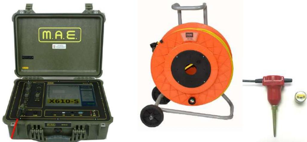
**Figura 1.** Sismografo digitale X610-S (a sinistra), rullo con cavo a 24 prese (al centro) e geofono verticale a 14 Hz (a destra) della M.A.E..
