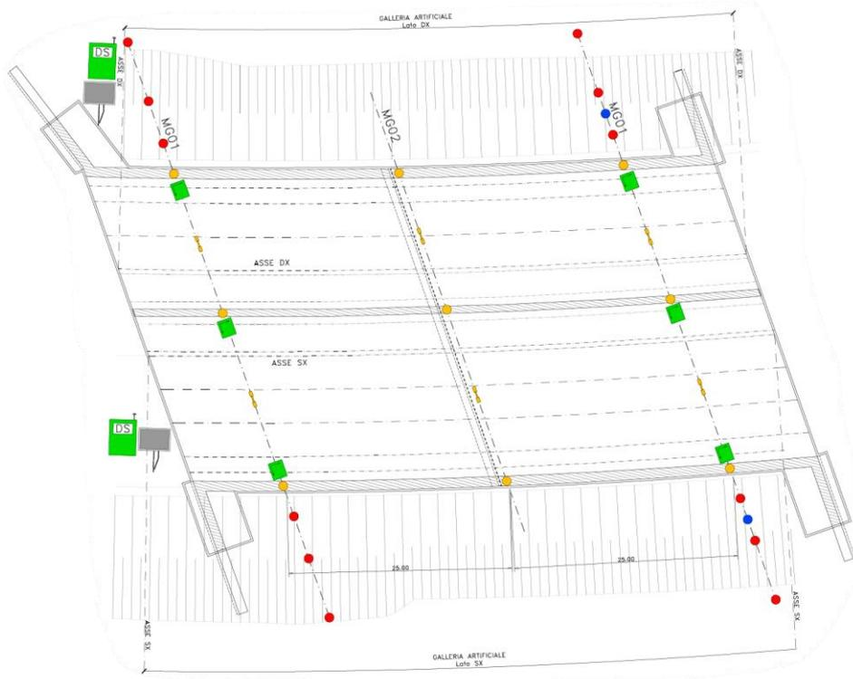
Figura 7-7 Pianta galleria con posizionamento strumentazione
