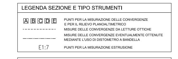
NOTE: - TUTTE LE MISURE SONO ESPRESSE IN m SALVO ESPRESSAMENTE SPECIFICATO - LA POSIZIONE DEI BULLONI PER LA MISURA DELLE CONVERGENZE E' INDICATIVA E ANDRA' ADOTTATA IN SITO SULLA BASE DELLE POSSIBILITA' DI POSIZIONAMENTO DEL TUBO DI VENTILAZIONE. I BULLONI PER LA MISURA DELLE CONVERGENZE SARANNO FISSATI IN ROCCIA. SOLO IN CASI ECCEZIONALI, PREVIA AUTORIZZAZIONE DELLA A.S., ESSI POTRANNO
