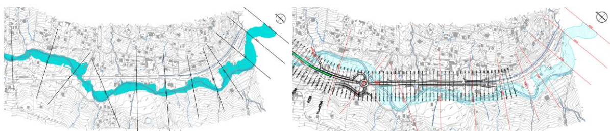
Figura 3.5-11 Fiume Milicia – ante operam e post operam Interferenza con le pile del viadotto VI
