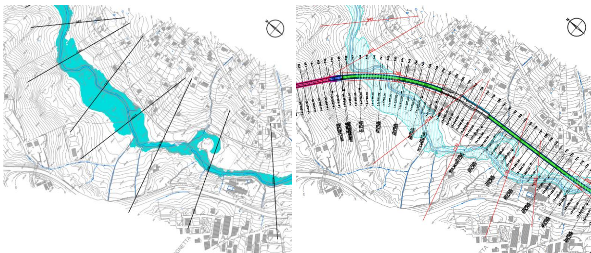
Figura 3.5-10 Fiume Milicia – ante operam e post operam Interferenza con le pile del viadotto VI
