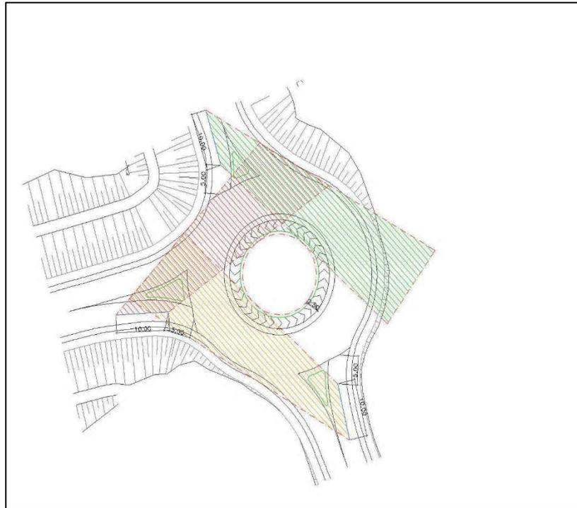
Figura 45 – Rotatoria SV\_04\_ROT\_E – Verifica visibilità a sinistra.
