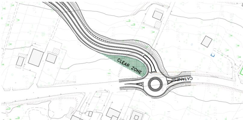
1. Nello svincolo di Bolognetta Nord le corsie specializzate di diversione in carreggiata sx e di accelerazione in carreggiata dx appaiono dimensionate per  $V_p = 120$  km/h sebbene la viabilità in tale tratto sia di tipo C.
