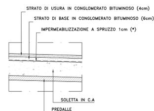
(\*) Impermeabilizzazione a spruzzo eseguita con prodotto elastomerico poliuretano bicomponente. Il rivestimento dovrà essere continuo e perfettamente impermeabile all'acqua, ma permeabile ai gas ed ai vapori acqueo. Spessore finito non inferiore a 3 mm.
