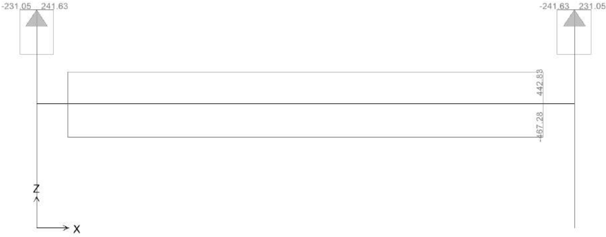
Figura 6.18. Trasverso di campata – Sforzo normale SLU
