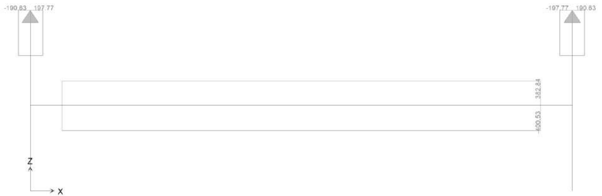
Figura 6.14. Trasverso di campata – Sforzo normale SLU
