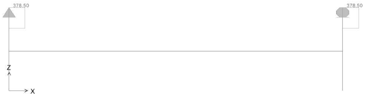
Figura 6.20. Trasverso di campata – Sforzo normale SLU2
