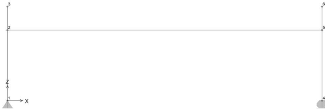
Figura 6.27. Modello di calcolo - Trasverso di appoggio - spalla
