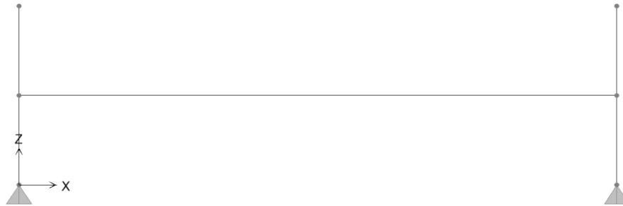
Figura 6.20. Modello di calcolo - Trasverso di appoggio - pila
