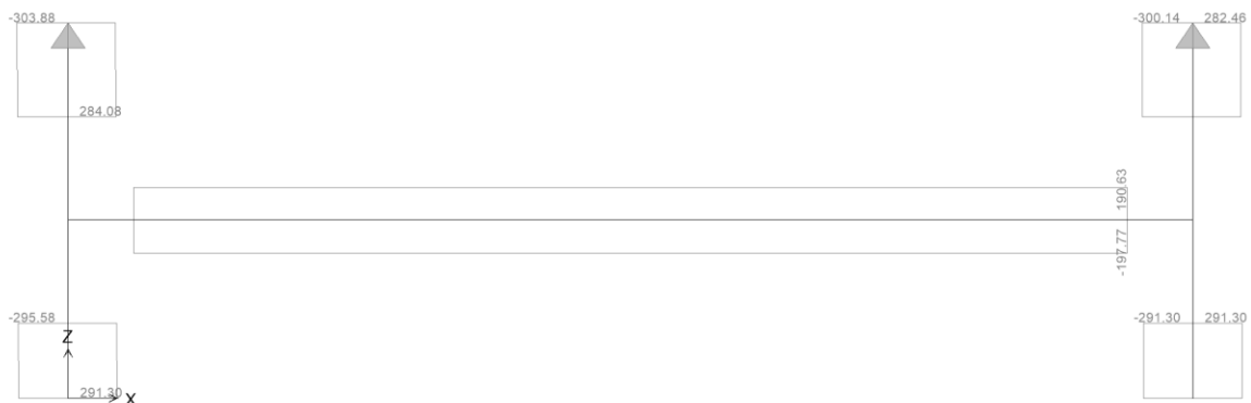
Figura 6.15. Trasverso di campata – Sforzo di taglio SLU
