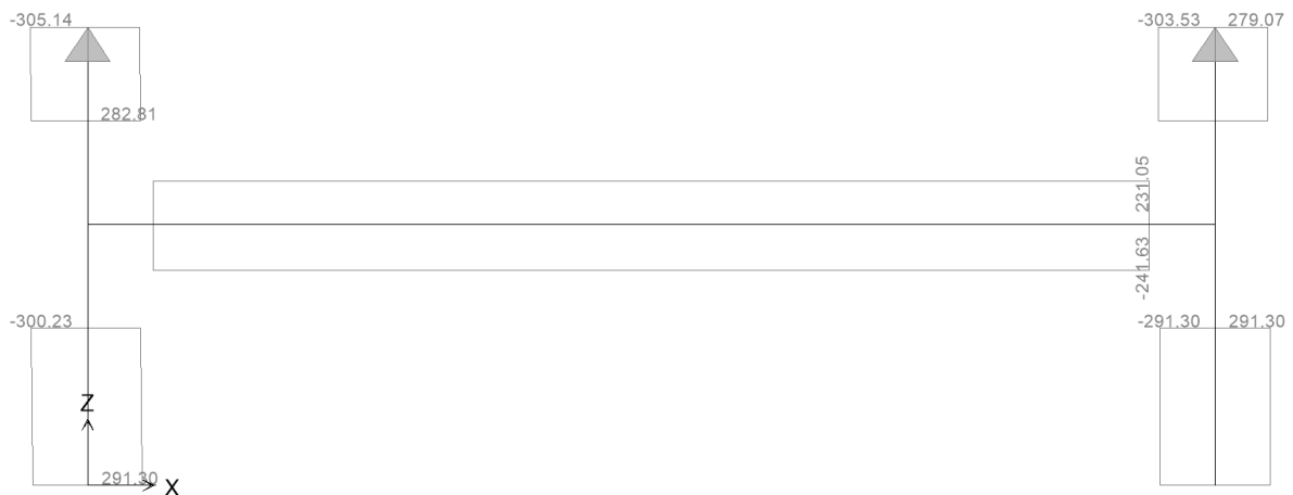
Figura 6.19. Trasverso di campata – Sforzo di taglio SLU
