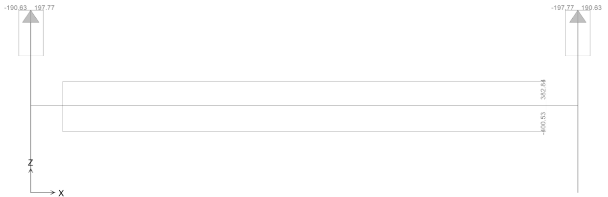
Figura 6.14. Trasverso di campata – Sforzo normale SLU
