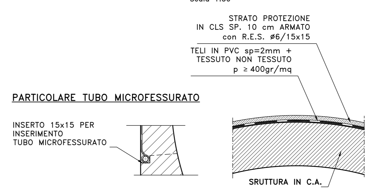
DETTAGLIO "2" IMPERMEABILIZZAZIONE Scala 1:50
