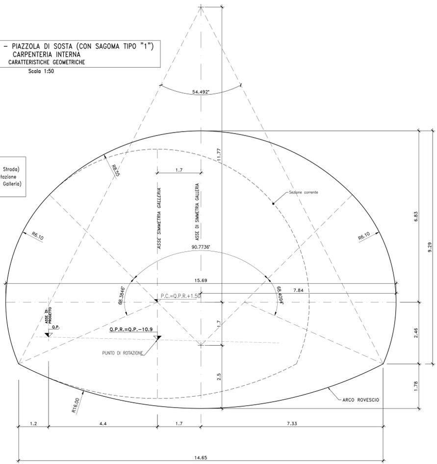
N.B. LA SEZIONE TIPO E' RIFERITA ALLA SINGOLA CARREGGIATA. LA DISTRIBUZIONE DELLE SEZIONI TIPO LUNGO IL TRACCIATO DELLE 2 CARREGGIATE E' RIPORTATA NELLA PLANIMETRIA DI PROGETTO
