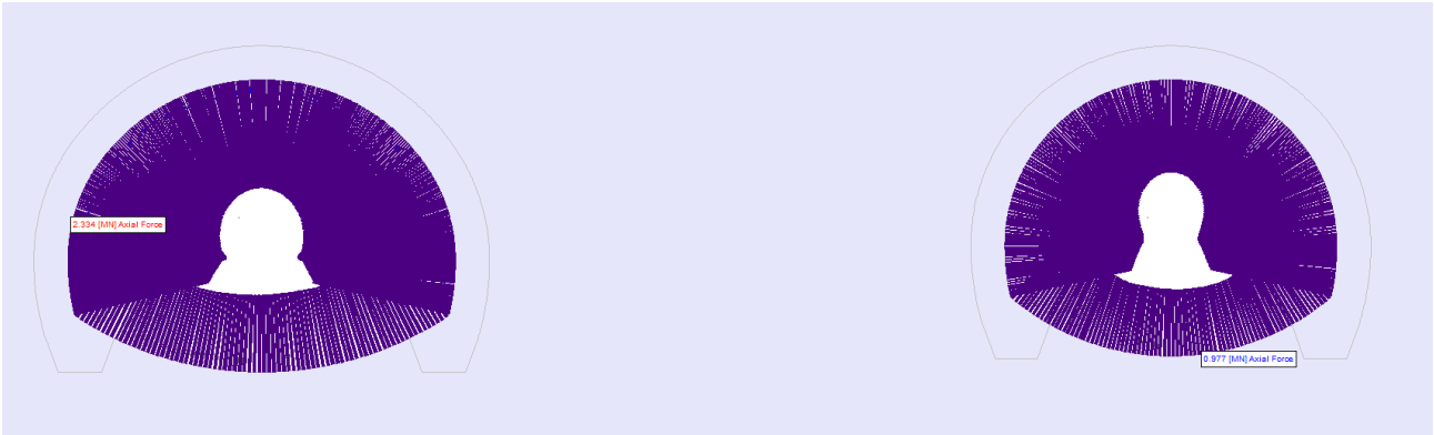
Figura. Sforzi normali su rivestimenti definitivi – Fase 11.
