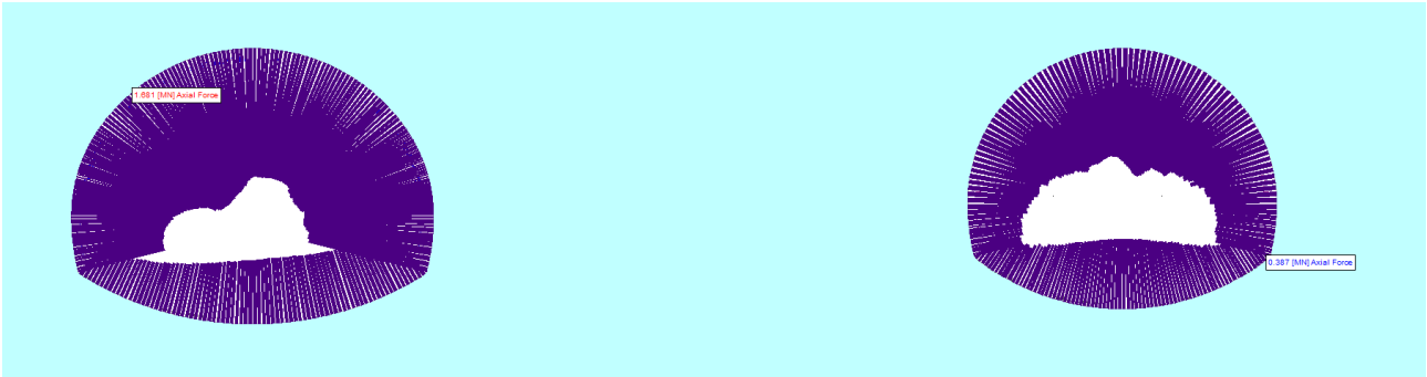
Figura. Sforzi normali su rivestimenti definitivi – Fase 11.
