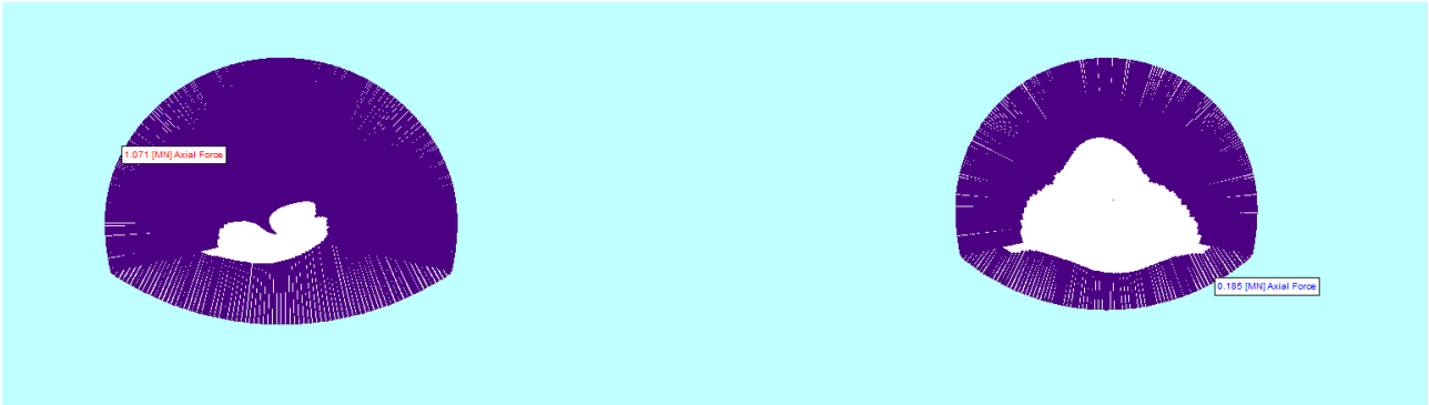
Figura. Sforzi normali su rivestimenti definitivi – Fase 11.
