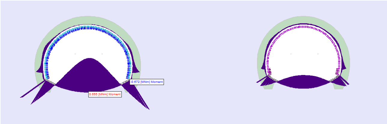
Figura. Momento su rivestimento di prima fase – Fase 4 e 9.
