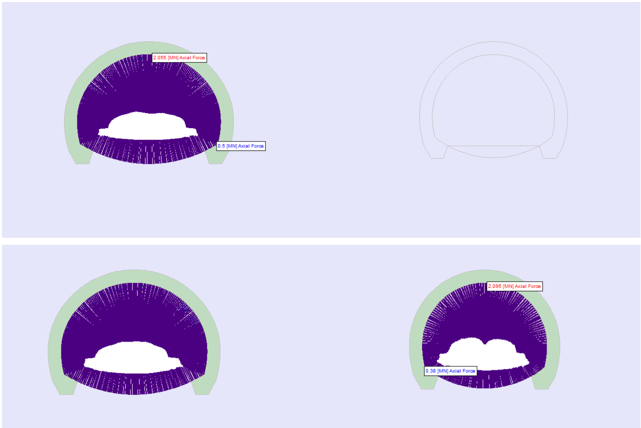
Figura. Sforzi normali su rivestimento di prima fase – Fase 4 e 9.
