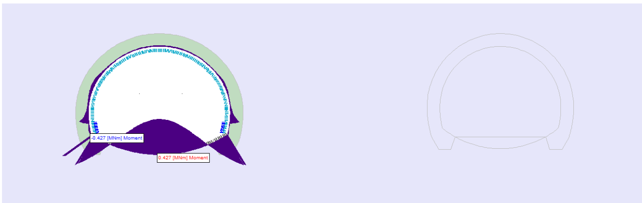
Figura. Sforzi normali su rivestimento di prima fase – Fase 4 e 9.
