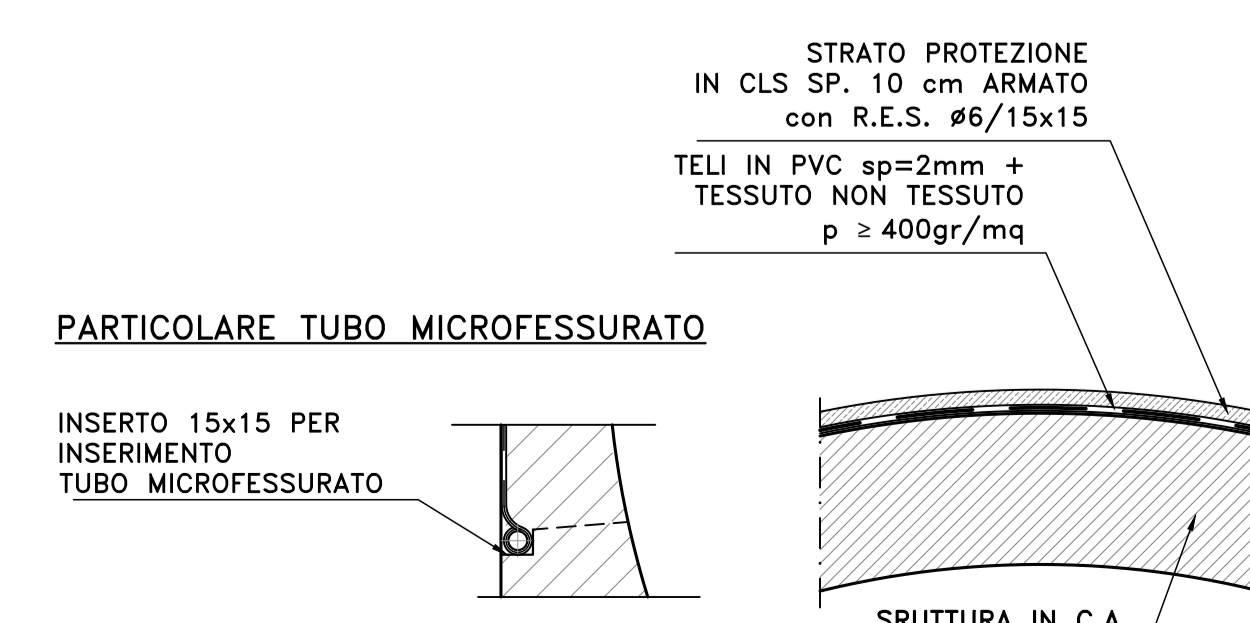
DETTAGLIO "2" IMPERMEABILIZZAZIONE Scala 1:50
