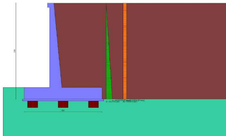
Fig. 7 - Diagramma delle pressioni (combinazione sismica) (Combinazione n° 3)
