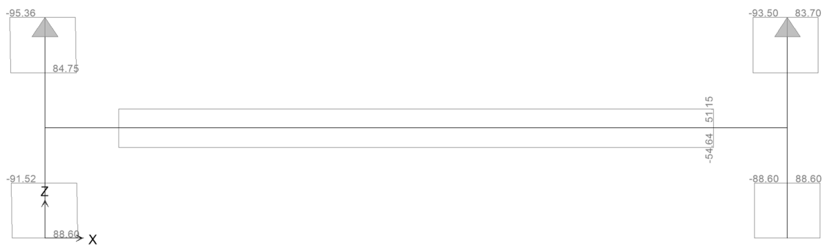
Figura 6.15. Trasverso di campata – Sforzo di taglio SLU
