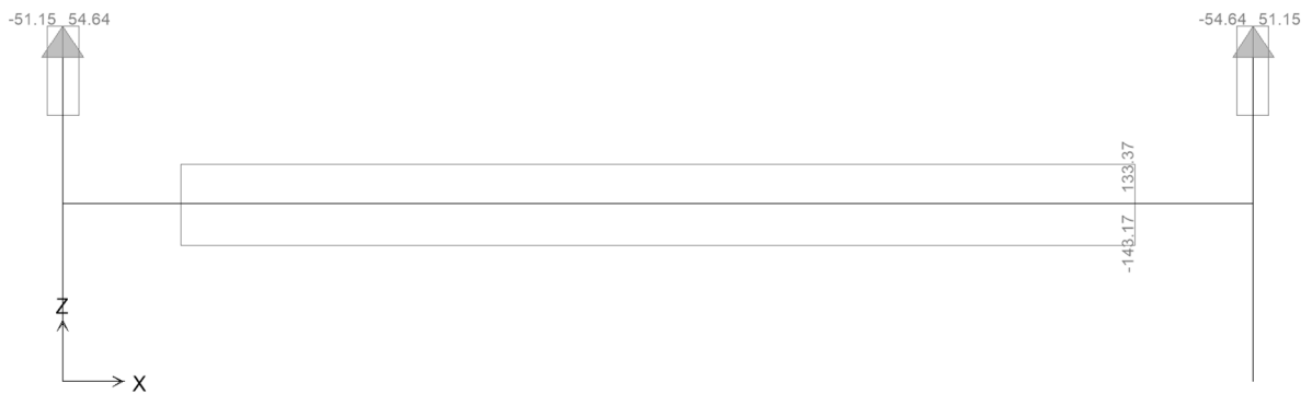
Figura 6.14. Trasverso di campata – Sforzo normale SLU
