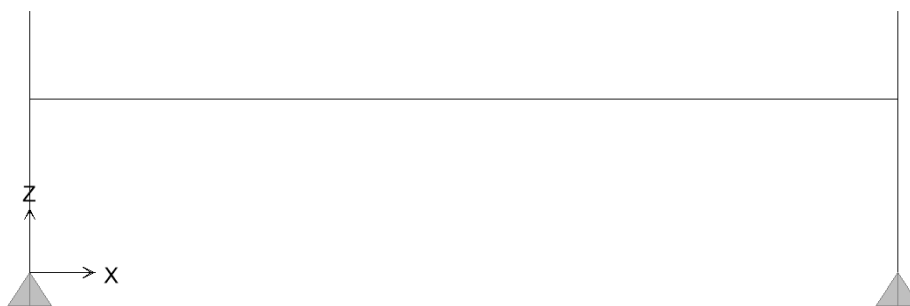
Figura 6.21. Modello di calcolo - Trasverso di appoggio – spalla
