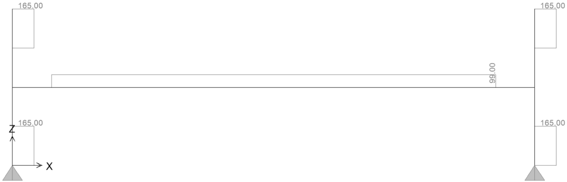
Figura 6.18. Trasverso di appoggio pila – Sforzo di taglio H_t\text{-SLV}
