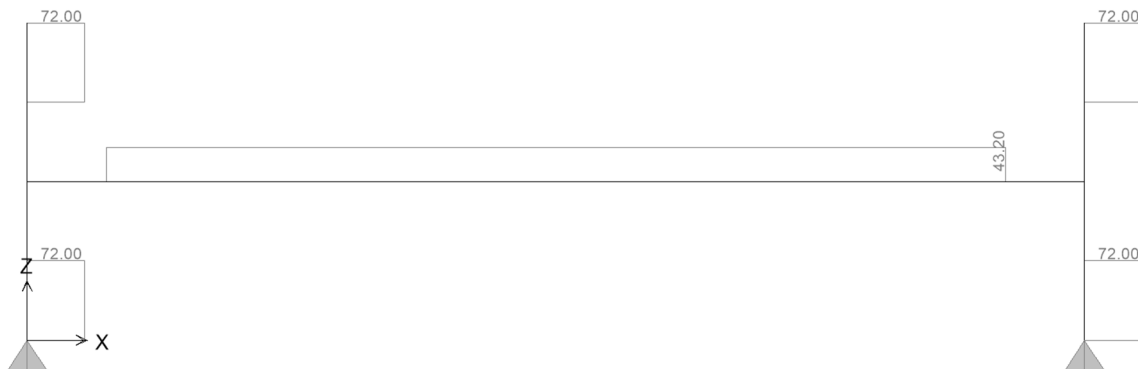
Figura 6.19. Trasverso di appoggio pila – Momento flettente Ht-vento
