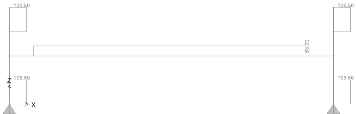
Figura 6.22. Trasverso di appoggio spalla – Momento flettente H_t\text{-SLV}
