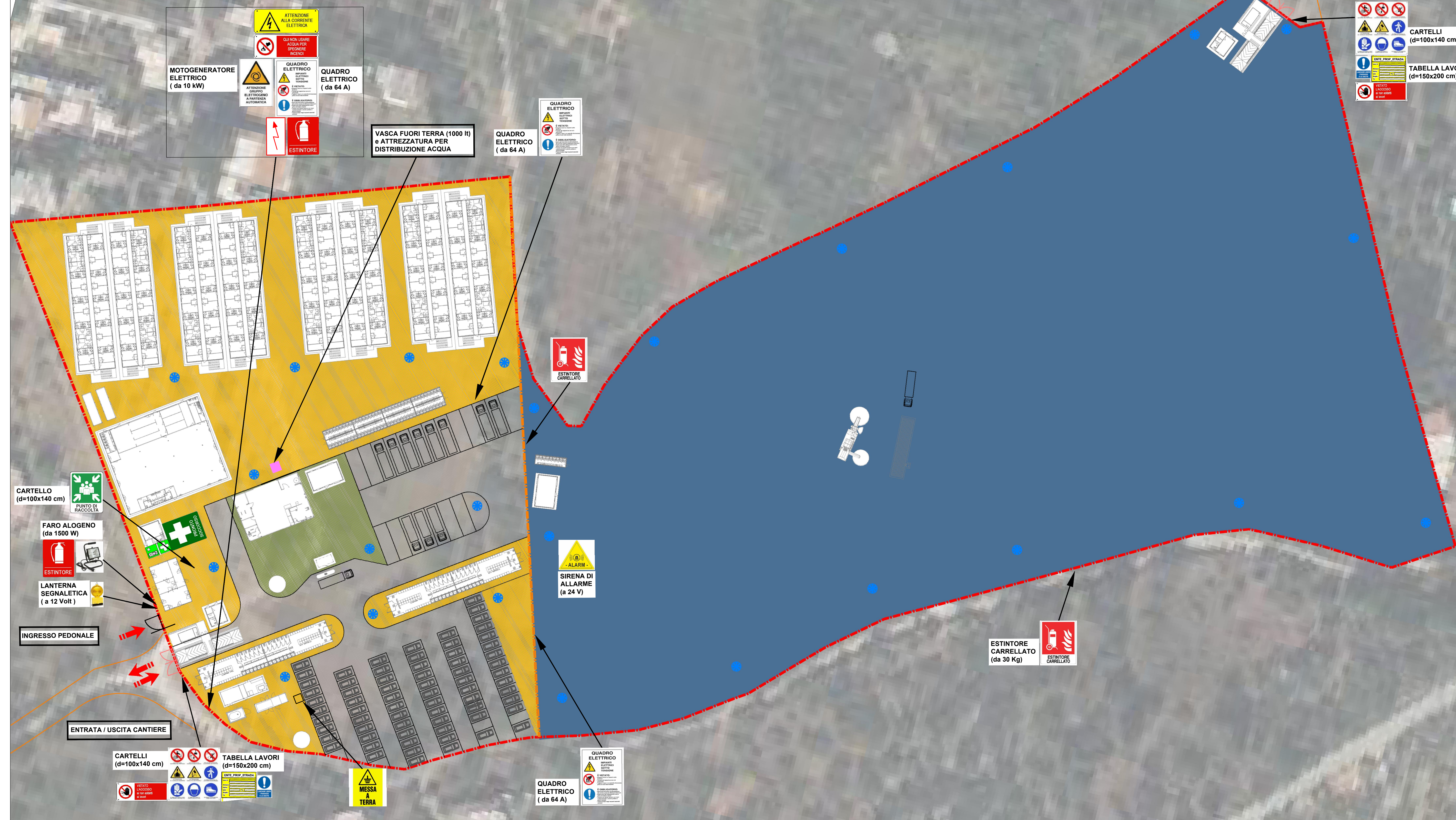
LAY-OUT DI CANTIERE (CANTIERE BASE CB01) SCALA 1:500
