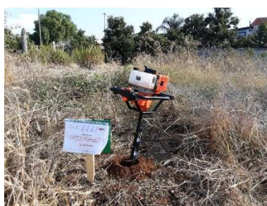
Figura 1 - Trivella a motore
