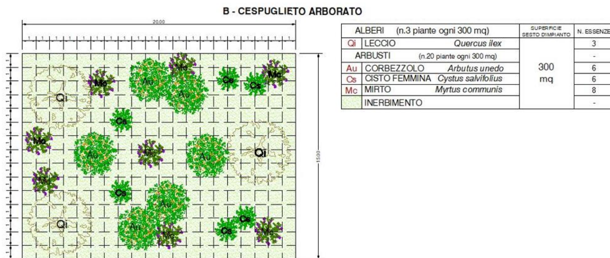
Figura 1-24 Sesto di impianto Tipologico B
