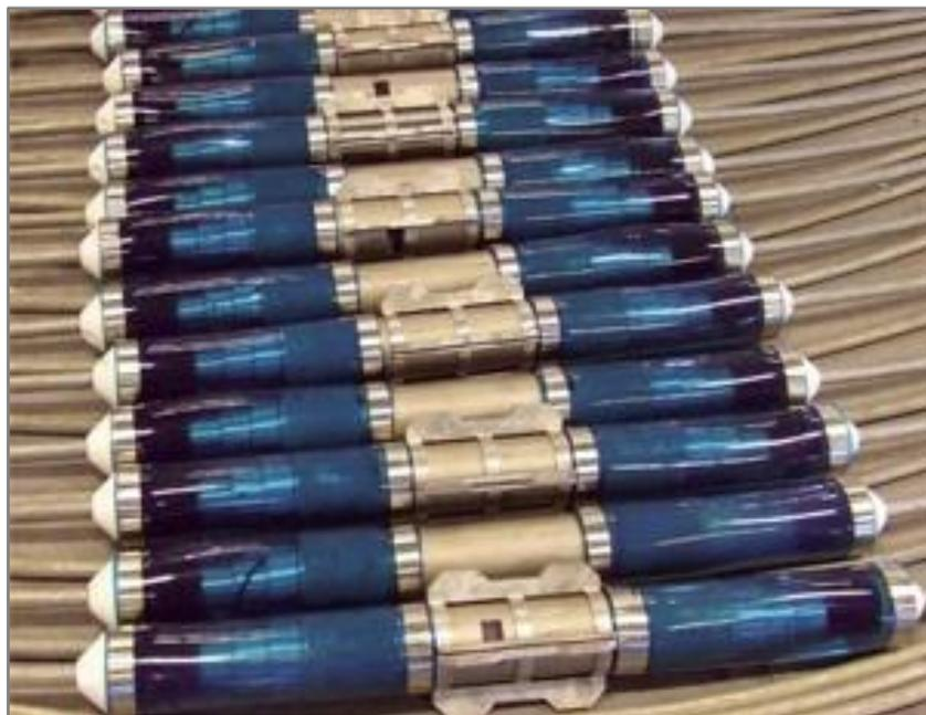
Figura 2.9 – Serie di idrofoni usati per l’acquisizione del segnale off-shore (fonte: [www.oilonline.com](http://www.oilonline.com)).
