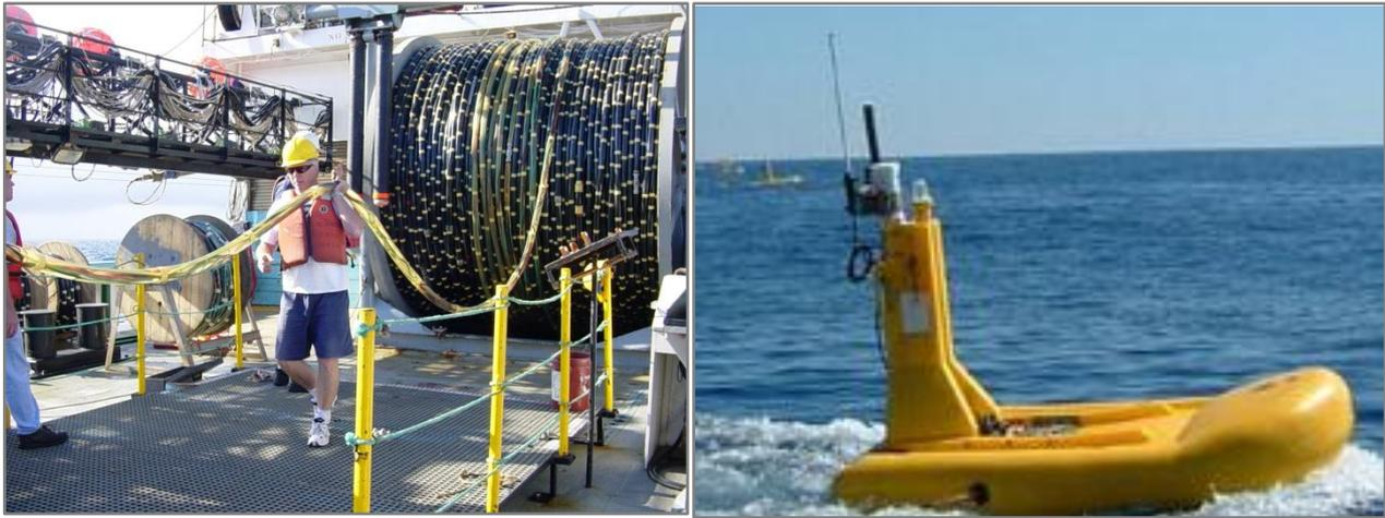
Figura 2.8 – Streamer o cavo sismico per l’acquisizione a sinistra (fonte: [www.ig.utexas.edu](http://www.ig.utexas.edu)) e Boa di coda a destra (fonte: [www.seamap.com](http://www.seamap.com)).
