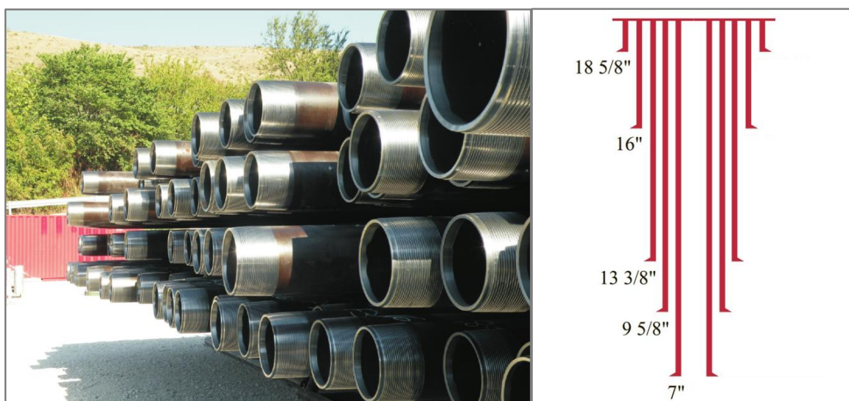
Figura 3.28 – Profilo di un pozzo. A destra è possibile osservare che il diametro del casing diminuisce con l'aumentare della profondità (fonte: Treccani, 2009). A sinistra particolare di una batteria di casing
