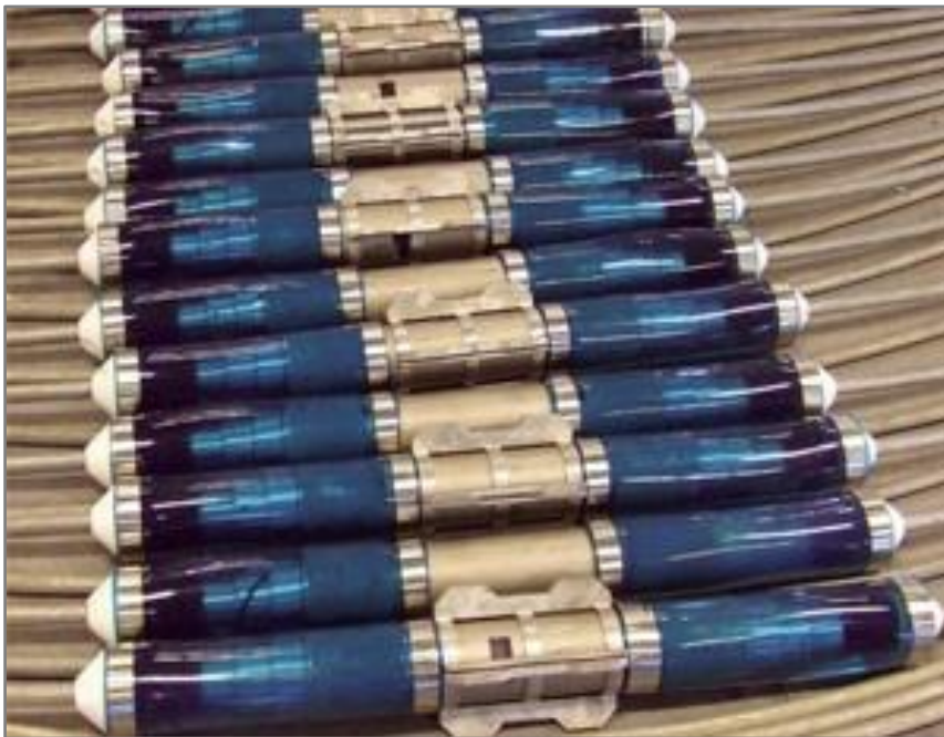
Figura 2.9 – Serie di idrofoni usati per l'acquisizione del segnale off-shore (fonte: www.oilonline.com ).
