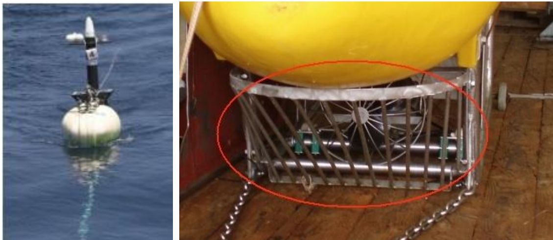
Figura 6.1 – A sinistra: esempio di boa di coda, fissata all’estremità del cavo sismico. A destra: dispositivo che esclude la possibilità di intrappolamento delle tartarughe marine (fonte: www.ketosecology.co.uk )
