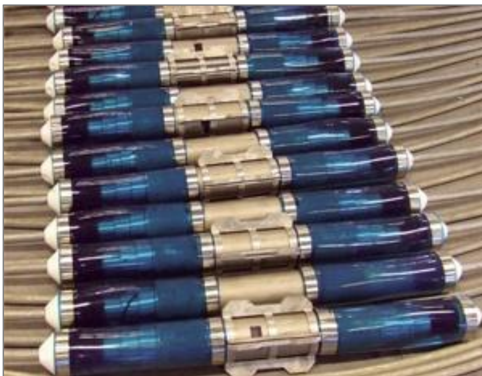
Figura 3.27 – Serie di idrofoni usati per l'acquisizione del segnale off-shore (fonte: www.oilonline.com )
