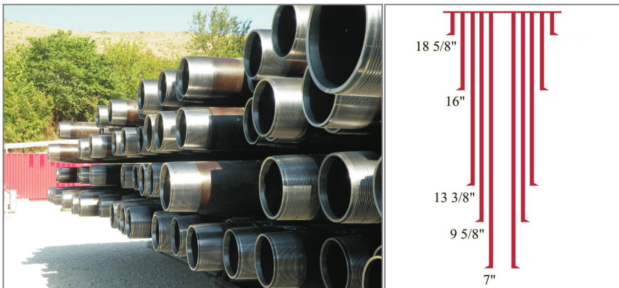
Figura 2.14 – Profilo di un pozzo. A destra è possibile osservare che il diametro del casing diminuisce con l'aumentare della profondità (fonte: Treccani, 2009). A sinistra particolare di una batteria di casing.
