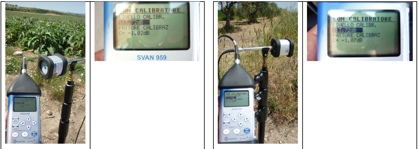
Figura 4 - Calibrazione iniziale-finale della catena fonometrica
