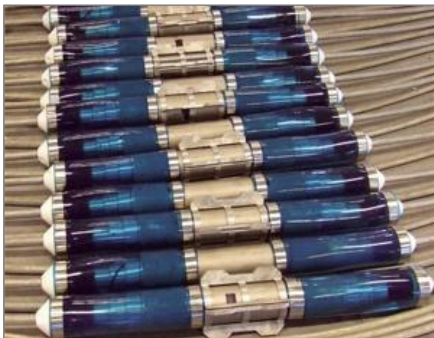
Figura 3.23 – Serie di idrofoni usati per l'acquisizione del segnale off-shore (fonte: www.oilonline.com ).
