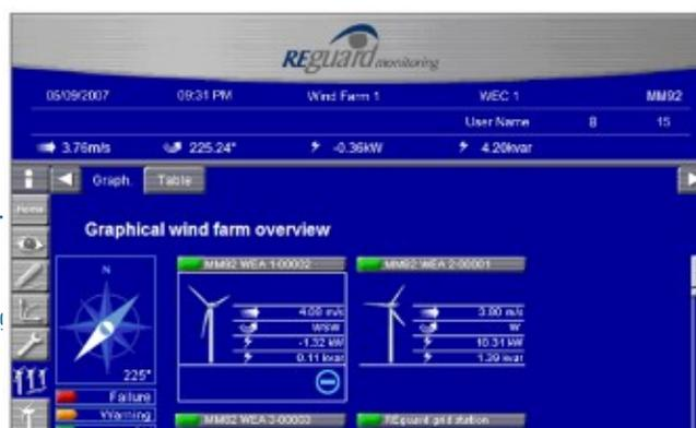
Figura 2 - SCADA – Visualizzazione Stato del Parco Eolico.
