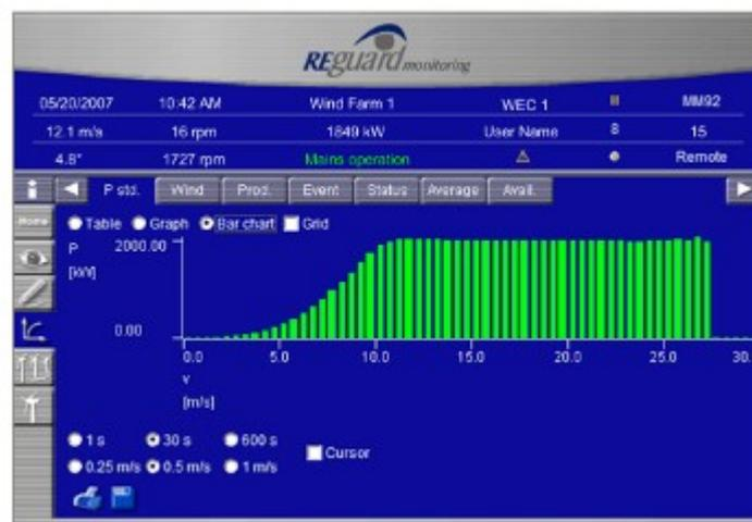
Figura 3 - SCADA – Visualizzazione Curva di Potenza – Velocità.
