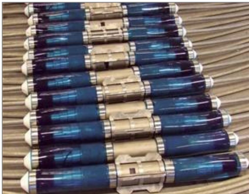
Figura 3.25 – Serie di idrofoni usati per l’acquisizione del segnale off-shore (fonte: www.oilonline.com ).
