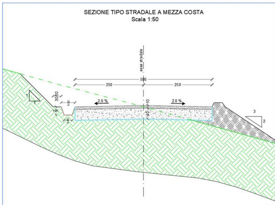
Sezione tipo stradale a mezza costa
