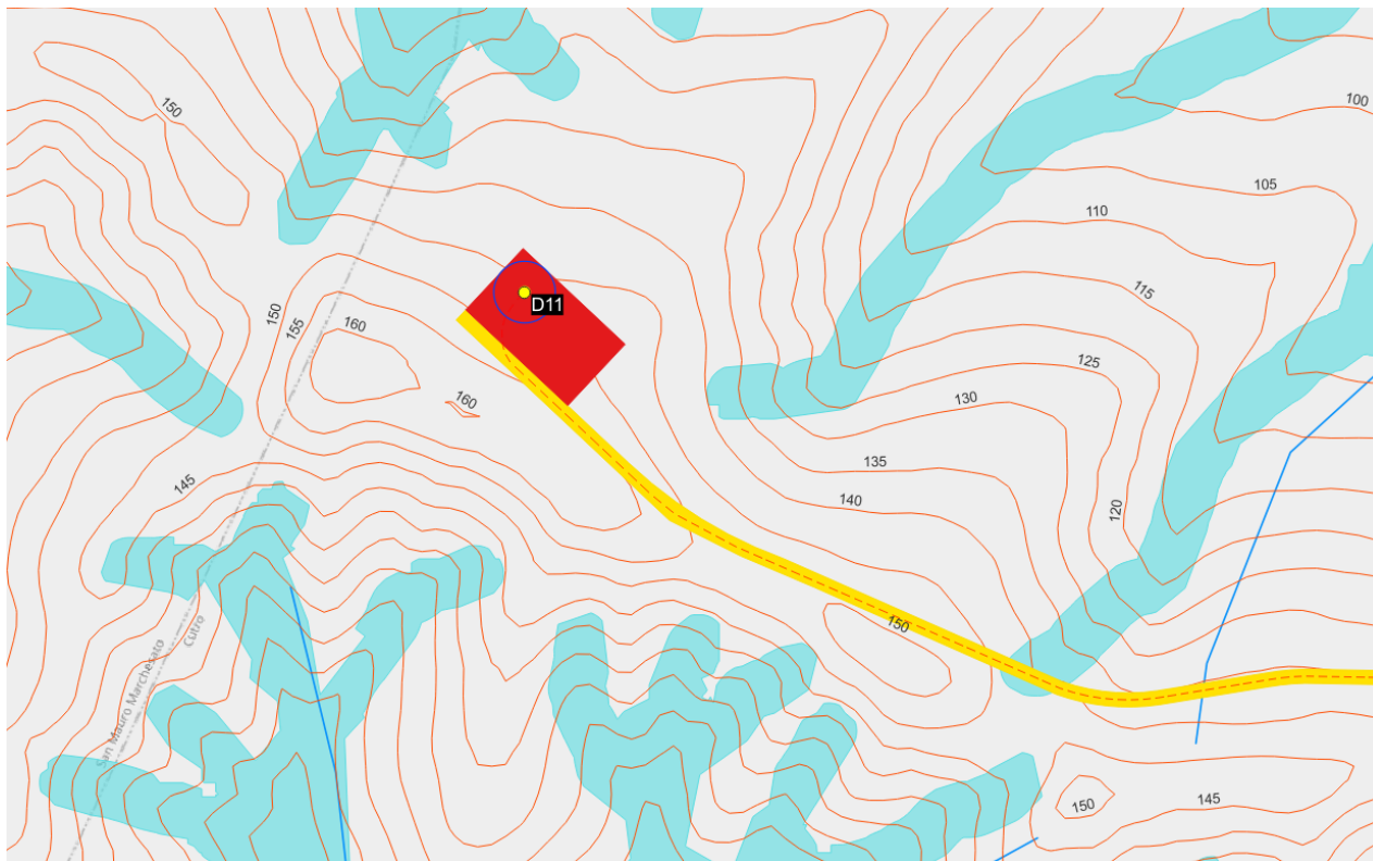
Figura 6-14 – Inquadramento D11 rispetto ai corsi d'acqua e alle aree di attenzione del PGRA con curve di livello.
