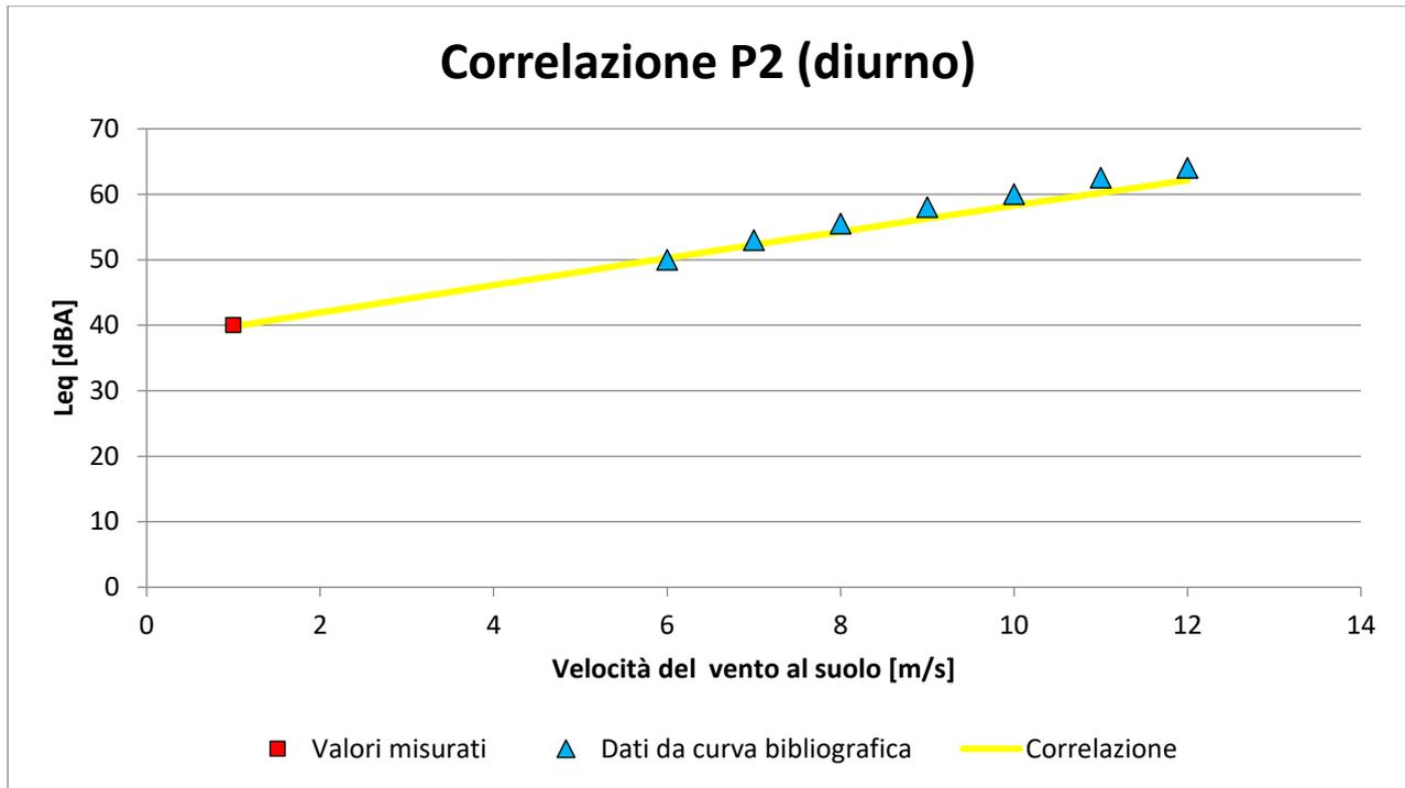
Figura 9-5 – Correlazione tra ventosità e  $L_{Aeq}$  al punto di misura P2
