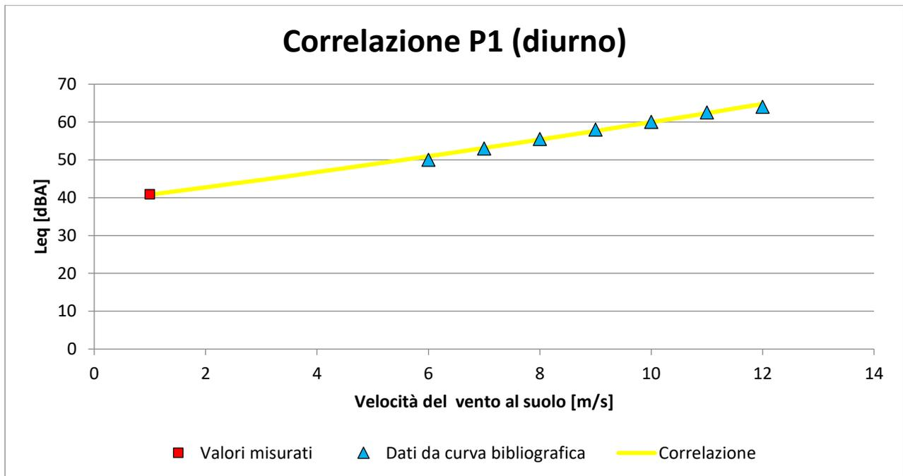
Figura 9-3 – Correlazione tra ventosità e  $L_{Aeq}$  al punto di misura P1
