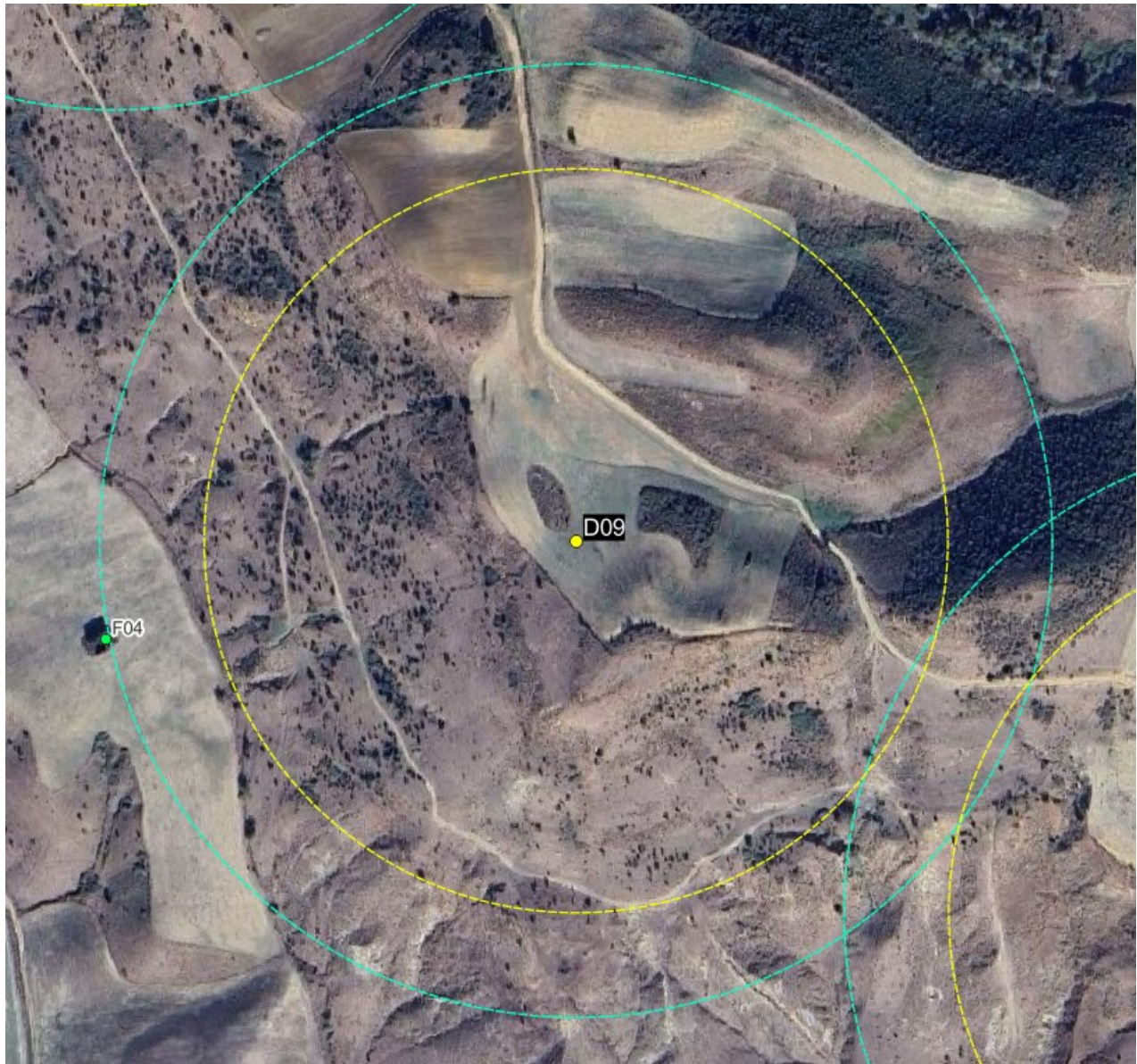
Figura 6-9 – Gittata dell'intera pala (246,6 m) in colore giallo e gittata del frammento di pala (316,0 m) in colore verde, da aerogeneratore D09
