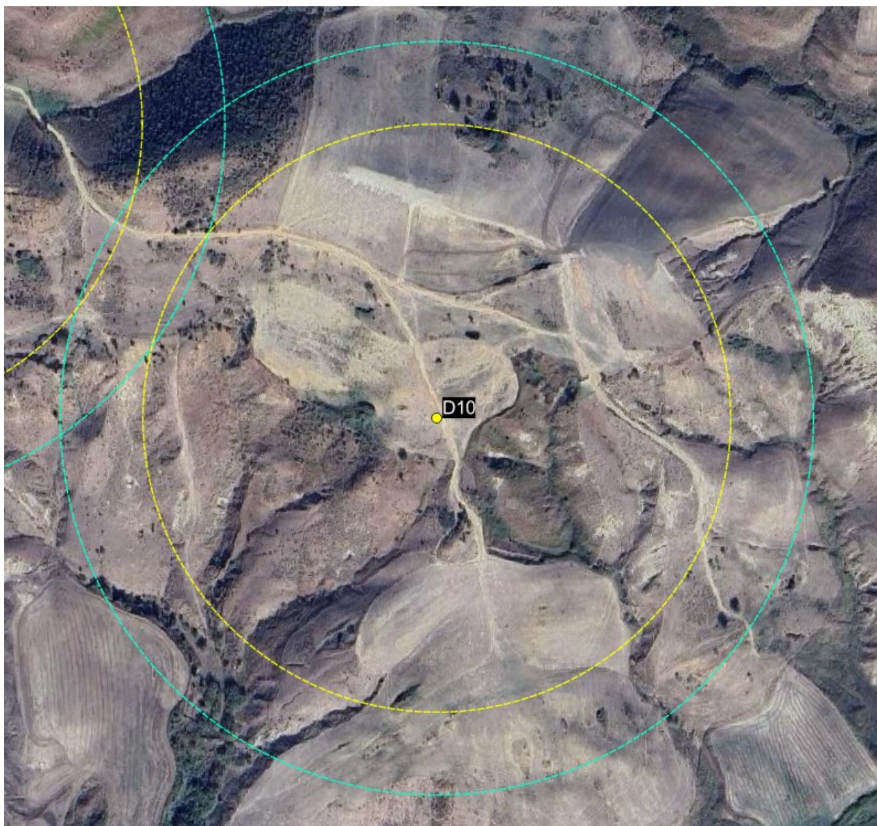
Figura 6-10 – Gittata dell'intera pala (246,6 m) in colore giallo e gittata del frammento di pala (316,0 m) in colore verde, da aerogeneratore D10
