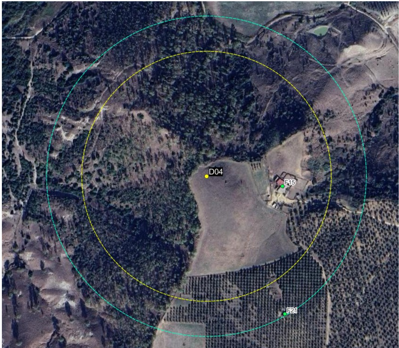
Figura 6-4 – Gittata dell'intera pala (246,6 m) in colore giallo e gittata del frammento di pala (316,0 m) in colore verde, da aerogeneratore D04
