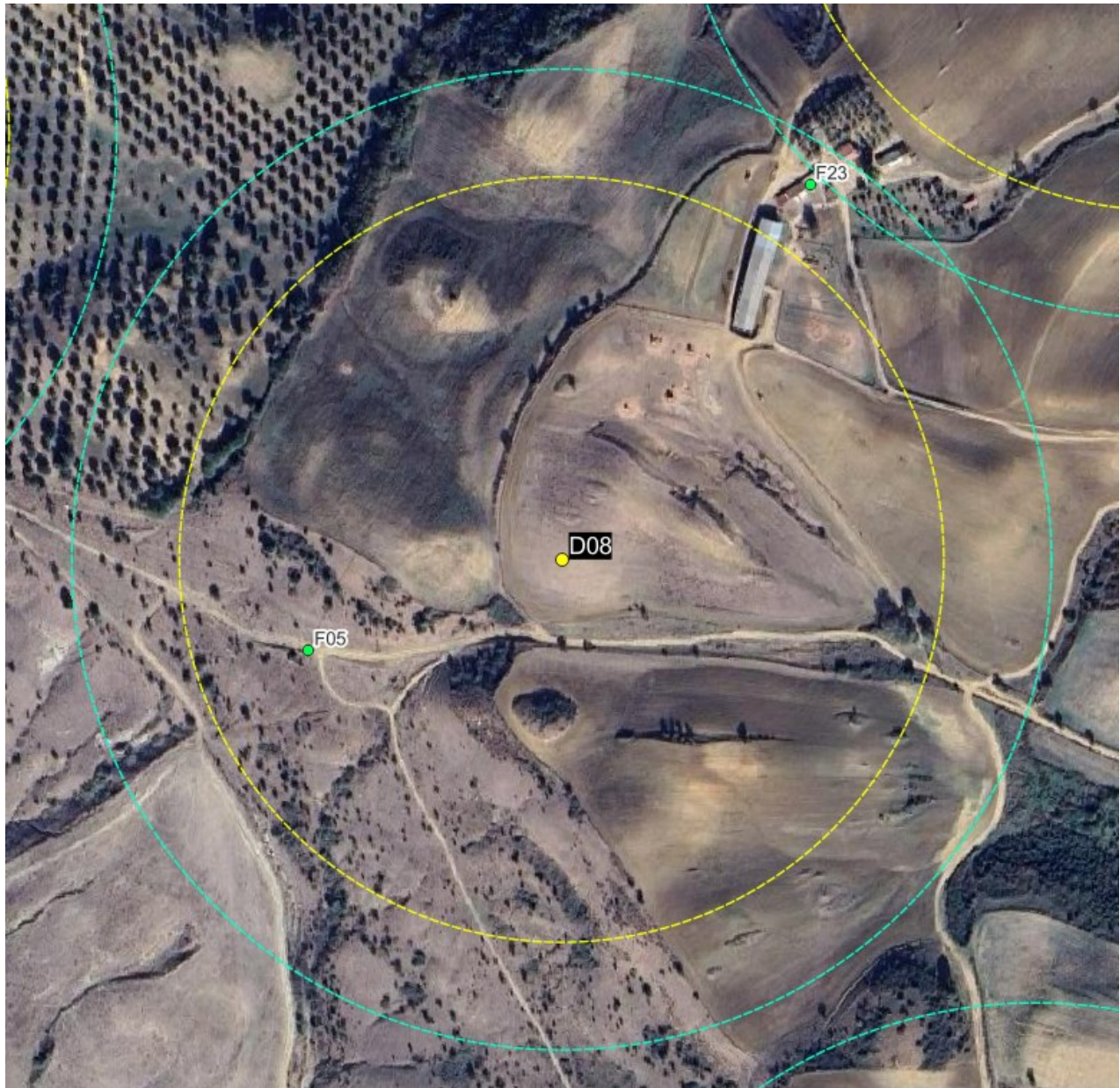
Figura 6-8 – Gittata dell'intera pala (246,6 m) in colore giallo e gittata del frammento di pala (316,0 m) in colore verde, da aerogeneratore D08
