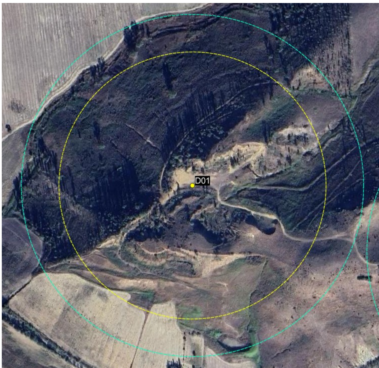
Figura 6-1 – Gittata dell'intera pala (246,6 m) in colore giallo e gittata del frammento di pala (316,0 m) in colore verde, da aerogeneratore D01
