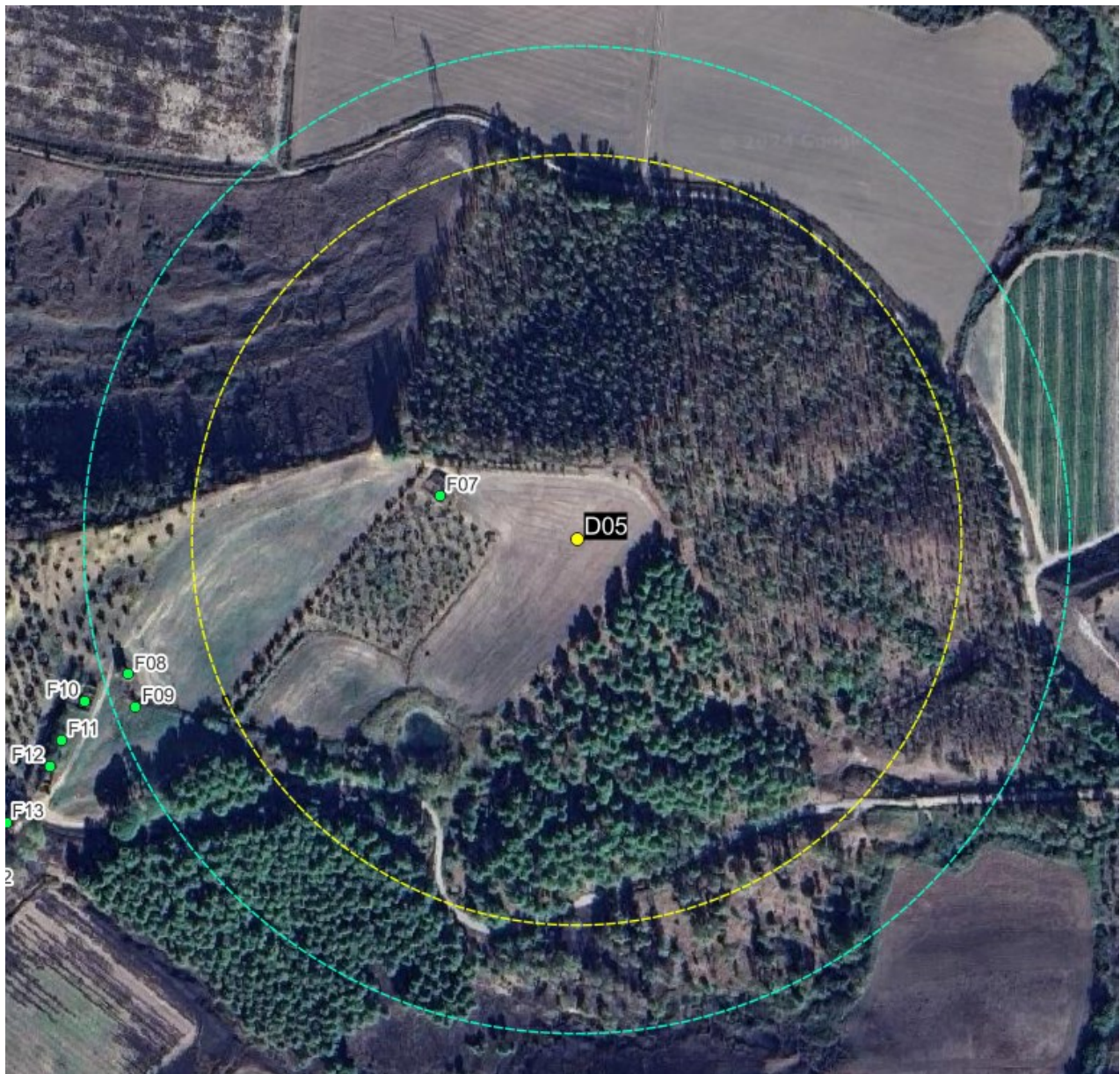
Figura 6-5 – Gittata dell'intera pala (246,6 m) in colore giallo e gittata del frammento di pala (316,0 m) in colore verde, da aerogeneratore D05
