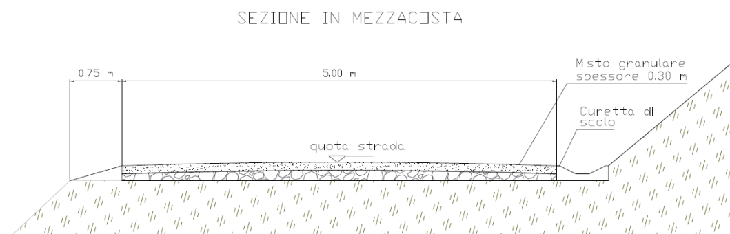
Figura 5-4 – Tipico di strada di accesso al parco eolico in mezzacosta
